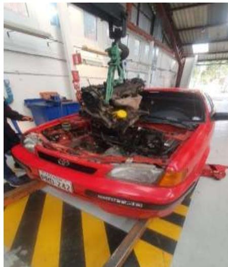
*Figura 4. Proceso de desmontaje del motor.*
