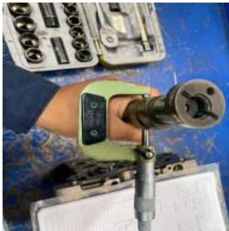
*Figura 18. Medición de la altura del lóbulo.*
