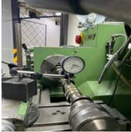
*Figura 17. Medición de descentramiento circular del eje de levas.*
