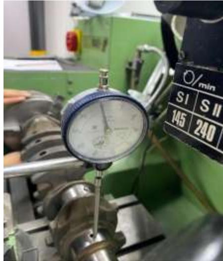
Figura 16. Medición de descentramiento circular del cigüeñal.
