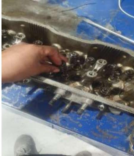
*figura 6. Desmontaje de los muelles de válvulas.*
