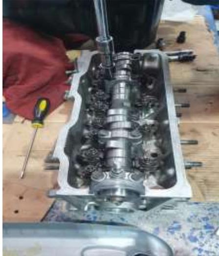
*Figura 21. Montaje del eje de levas en la culata.*
