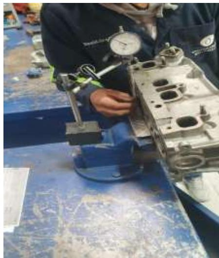
Figura 15. Medición excentricidad radial de la válvula.
