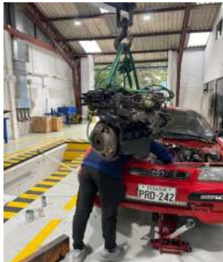
*Figura 23. Montaje del conjunto motor ya restaurado.*
