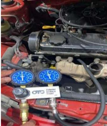
*Figura 2 . Comprobación de perdida de hermeticidad en los cilindros.*
