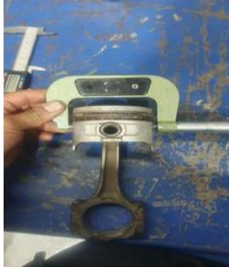
Figura 11. Medición del diámetro del pistón.
