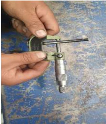
*Figura 13. Medición del vástago de la válvula.*
