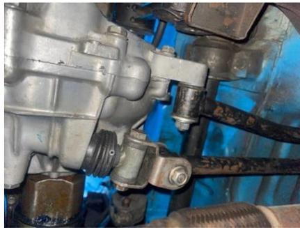
*Figura 28 Sistema de varillas selectoras*
