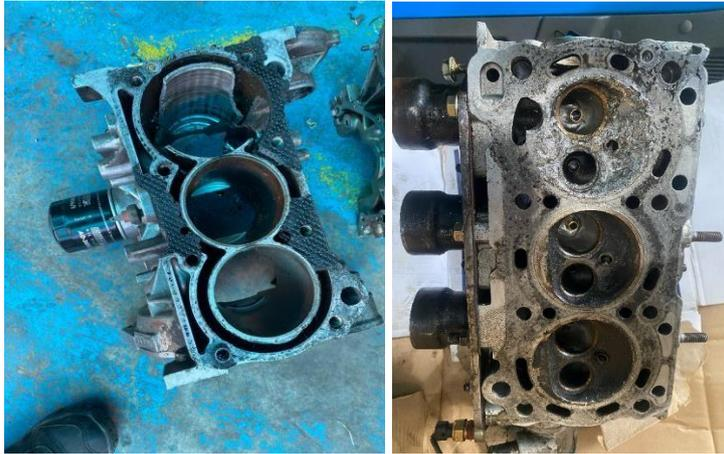
*Figura 1 Bloque motor afectado y culata*
