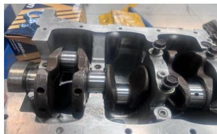
*Figura 5 Instalación del cigüeñal*
