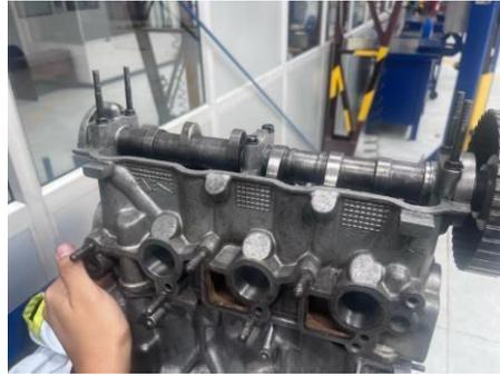
*Figura 15 Instalación de culata en el bloque motor*
