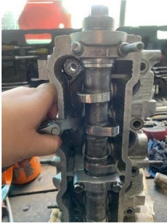
*Figura 11 Calibracion de propulsores*
