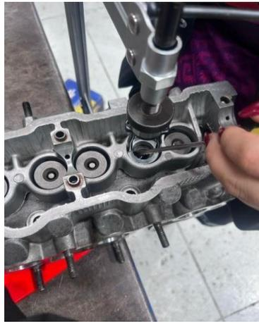
*Figura 10 Instalación de seguros*
