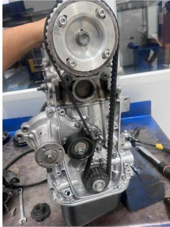
*Figura 17 Colocación de la correa de distribución*
