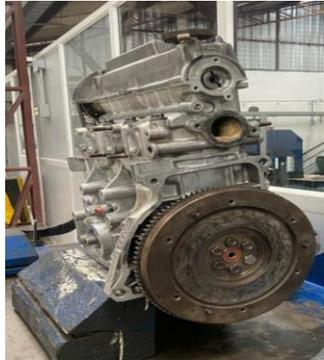
*Figura 19 Montaje del volante motor*
