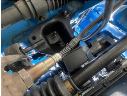
*Figura 31 Conexión del sensor de oxígeno*
