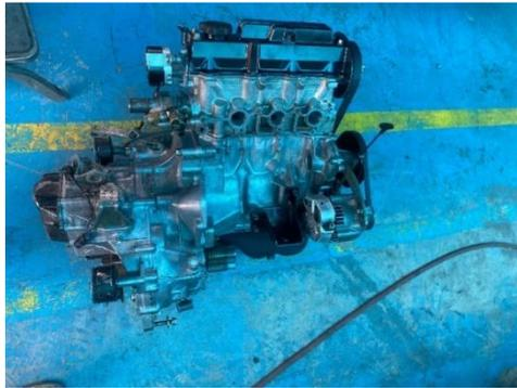
*Figura 21 Acople de motor con caja de cambios*
