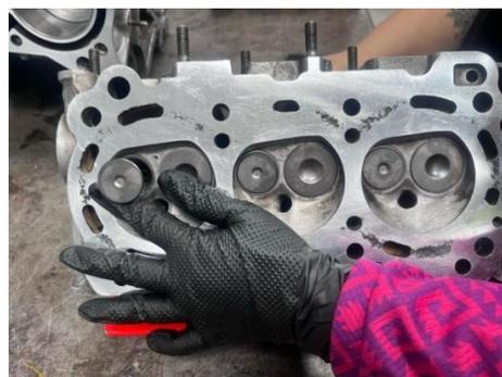
*Figura 9 Instalación de válvulas*
