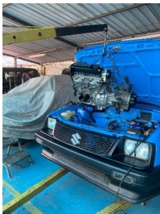
*Figura 22 Montaje del motor al chasis*
