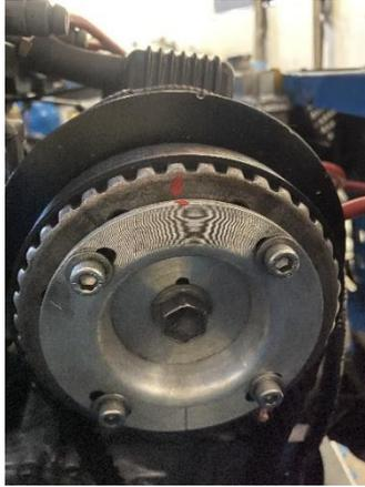
*Figura 35 Posición PMS de la polea*
