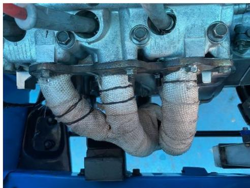
*Figura 25 Instalación de header*
