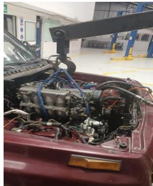
*Ilustración 21 Montaje del conjunto reparado motor*
