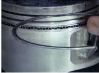
Ilustración 12 Medición de holgura canal rin-pistón
