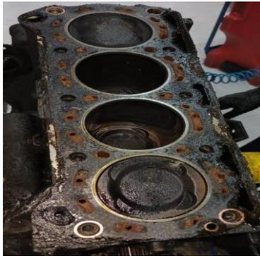
*Ilustración 8 Extracción del pistón*
