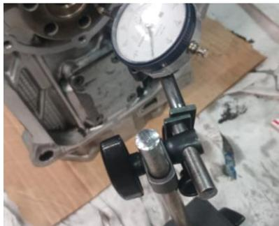
*Ilustración 17 Medición excentricidad radial de la válvula*
