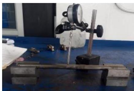
*Ilustración 15 Comprobación del descentramiento del eje de balancines*
