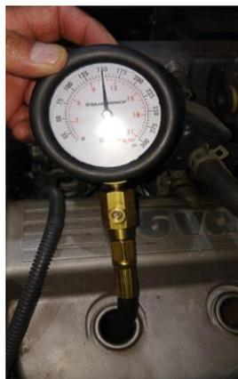
*Ilustración 1 Medición de compresión*
