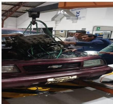
*Ilustración 5 Proceso de desmontaje del conjunto motor*
