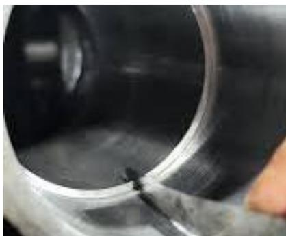
*Ilustración 11 Medición de luz de puntas*
