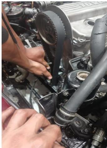
*Ilustración 20 Armado de la distribución*
