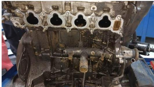
*Ilustración 3 Fuga de aceite en la distribución*
