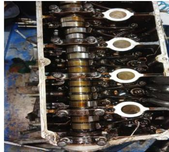
*Ilustración 6 Despiece de muelles, ejes y balancines*
