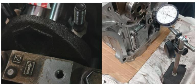
*Ilustración 14 Comprobación de juego axial del cigüeñal*
