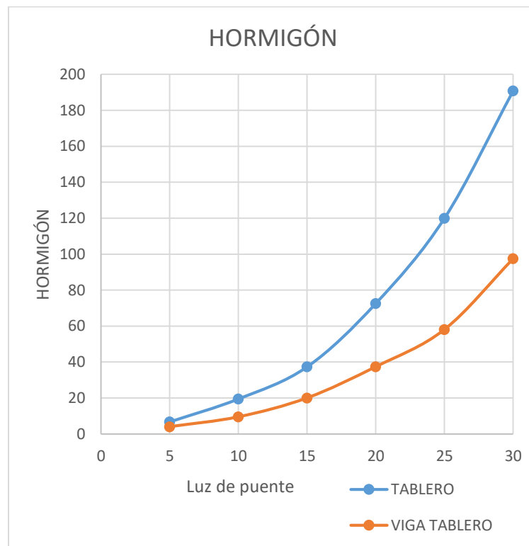
Figura 4.3: Hormigón requerido por los puentes Tablero y Viga-Tablero
