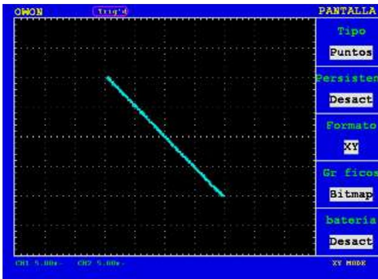
Imagen 10 - Representación de una resistencia.
