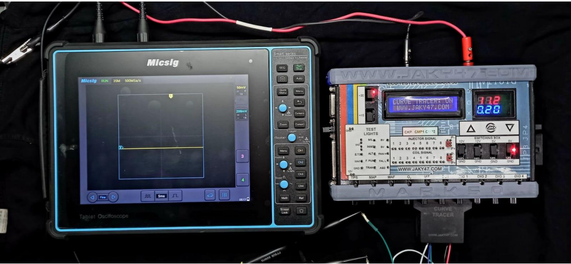
Imagen 19 -Adaptación de Osciloscopio y trazador de curvas
