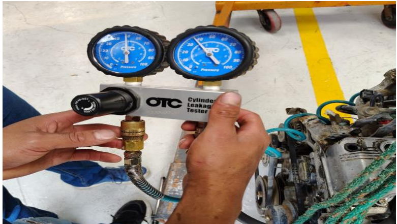
Figura 2. Comprobación de fugas de compresión.
