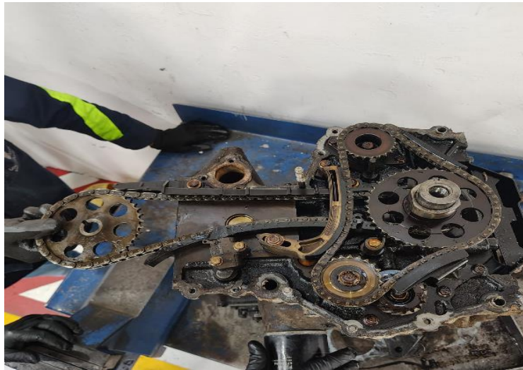
Figura 8.Desmontaje de tapa de distribución.
