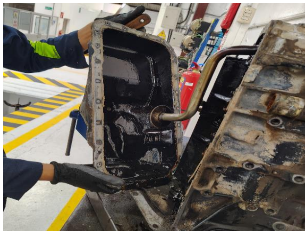
Figura 7. Desmontaje de cárter.
