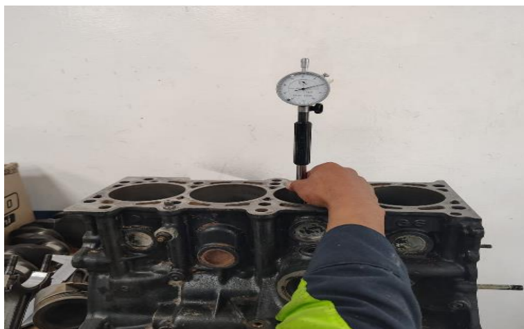
Figura 16. Medidas obtenidas de los cilindros
