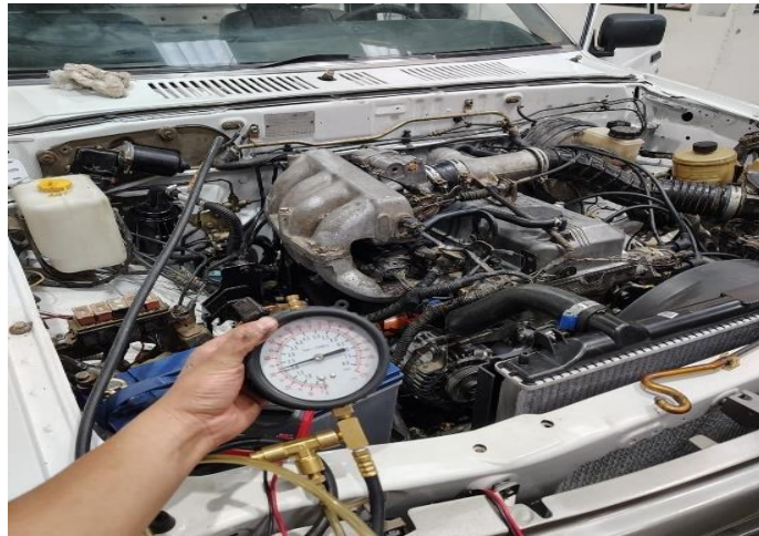
Figura 46. Prueba de presión de bomba de combustible.
