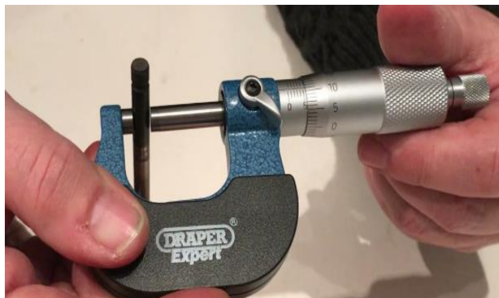
Figura 28. Medidas de vástago de válvula realizadas.
