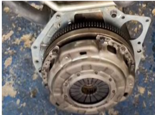
Figura 42. Montaje de volante de inercia y kit de embrague.
