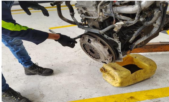
Figura 4. Desmontaje de disco y plato de embrague.
