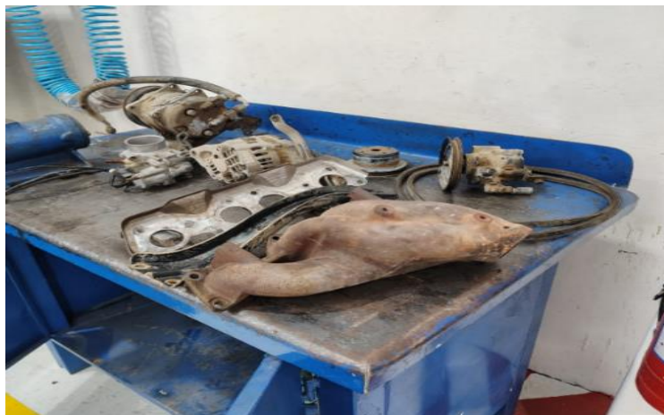
Figura 3. Desmontaje de los elementos exteriores del motor.
