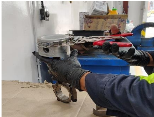
Figura 31. Montaje de anillos.
