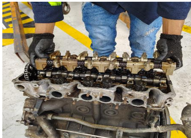
Figura 5. Desmontaje de balancines y árbol de levas.
