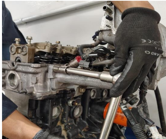
Figura 41. Montaje de múltiple de admisión.
