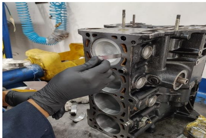
Figura 36. Comprobación de holgura lateral ente pistón y cilindro
