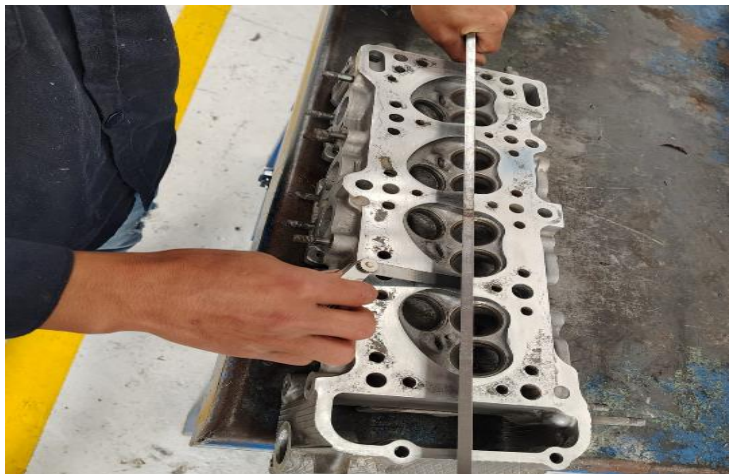
Figura 22. Medidas de planicidad realizadas.
