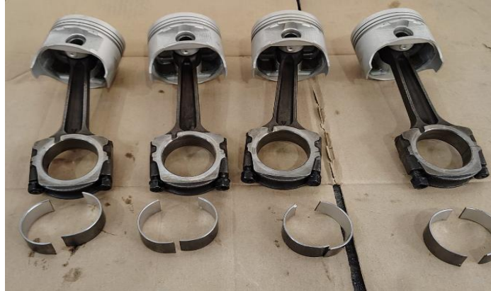
Figura 32. Montaje de cojinete de biela.
