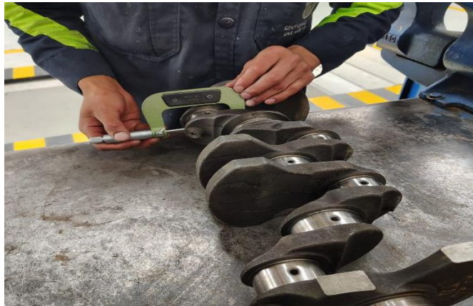
Figura 19. Medida de ovalización de cigüeñal
