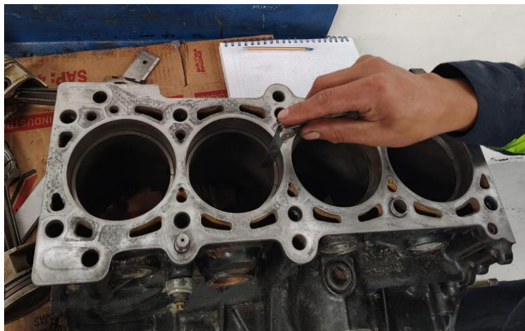
Figura 14. Verificación de luz de puntas.
