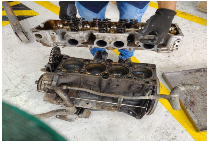
Figura 6. Desmontaje de culata.
