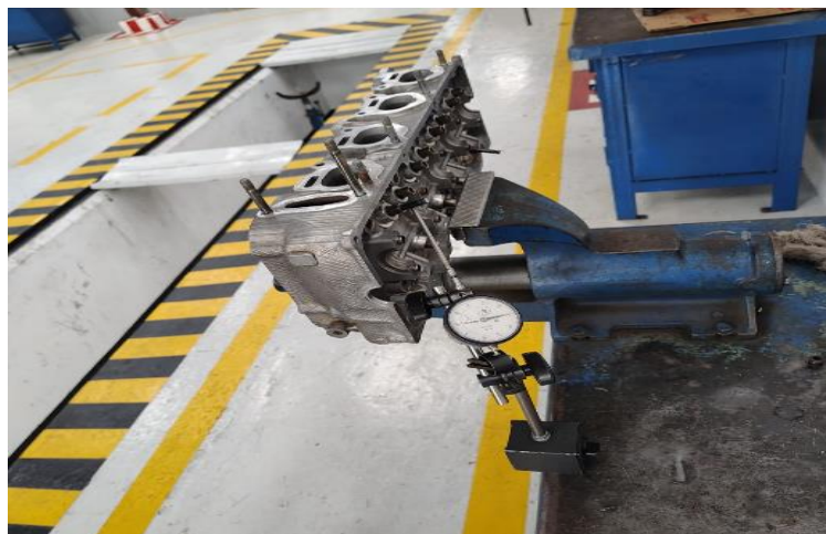
Figura 26. Comprobación de holgura de válvulas.
