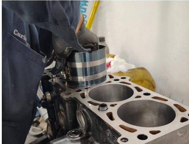
Figura 35. Instalación de pistones.
