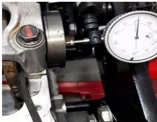
Figura 20. Comprobación de juego axial de cigüeñal.
