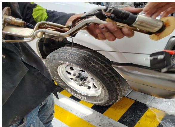
Figura 45. Reemplazo de bomba de combustible.
