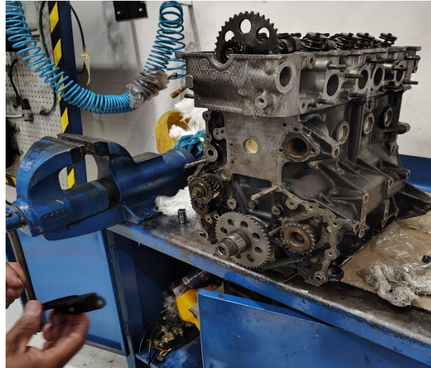
Figura 39. Montaje de piñones y cadena de distribución.
