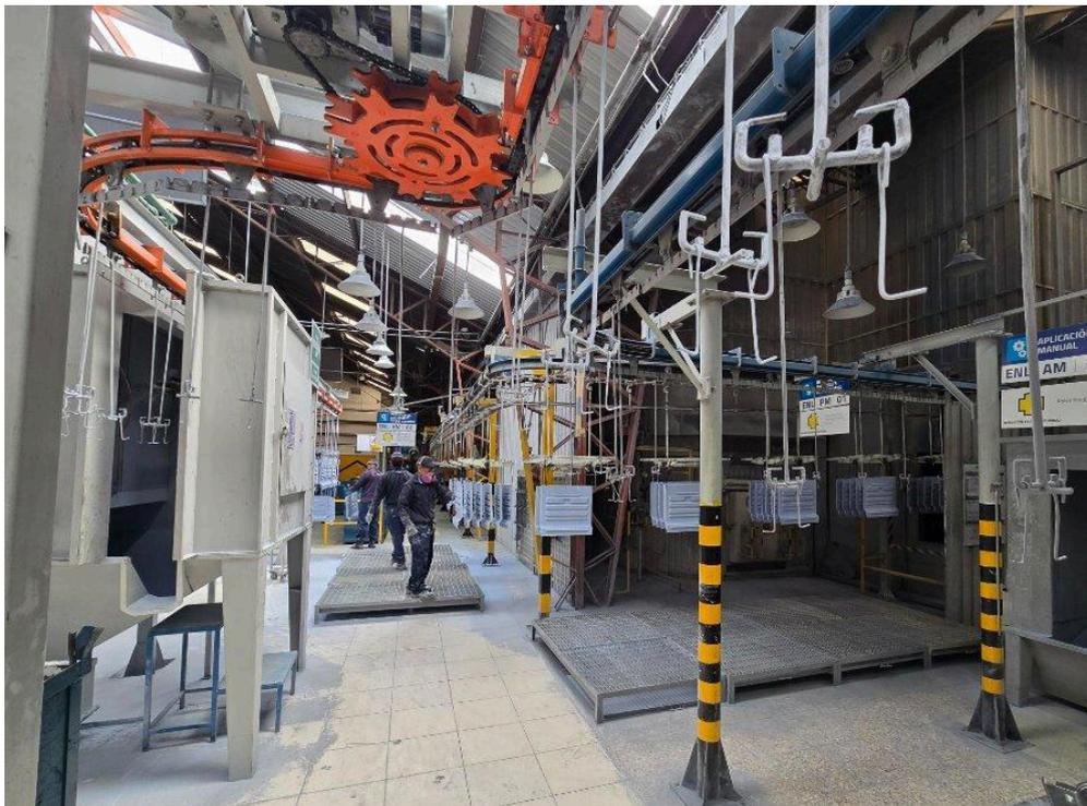
Figura 1: Proceso de aplicación y curado de piezas.
