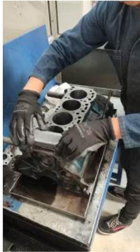
Concluida la limpieza, se procede con la instalación del cigüeñal. Para ello, colocamos los cojinetes de bancada nuevos en el bloque observando que los agujeros para la lubricación coincidan, ahora se realiza la prueba con hilo plástico (plastigauge) para verificar el juego radial.
