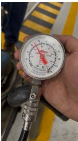
El procedimiento para medir las fugas de presión de compresión es: Instalar las bujías, excepto la del cilindro a medir
