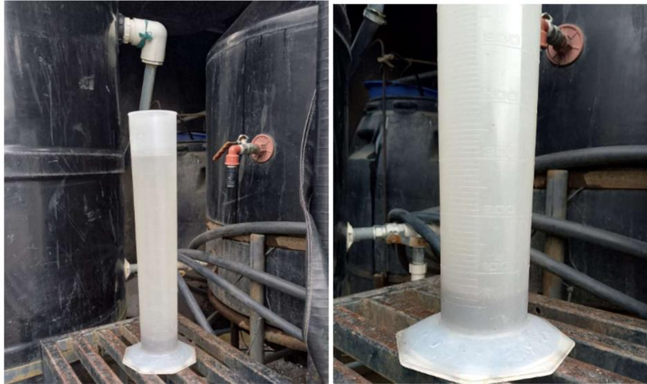
Figura 16 | Volumen sedimentado en 30 min
