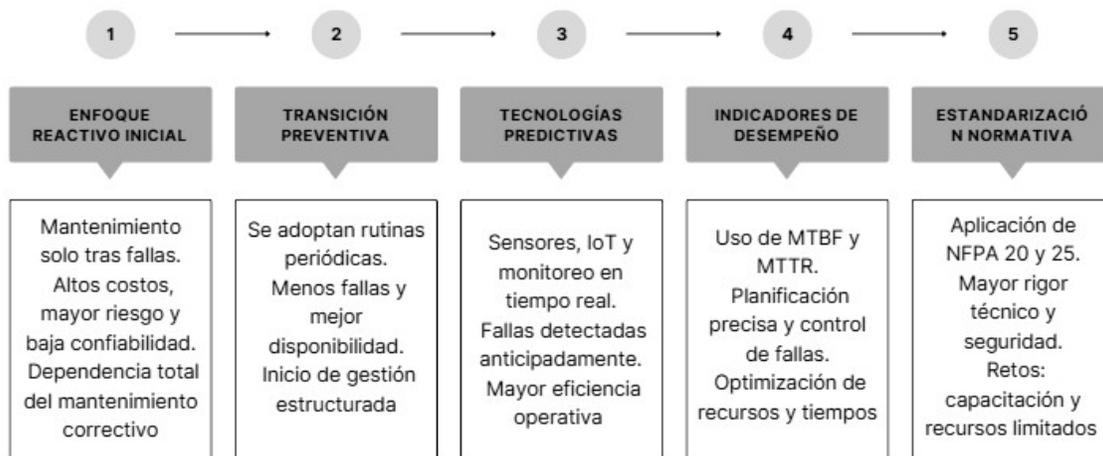
Figura 1: Road Map de la evolución del mantenimiento en sistemas contraincendios.
