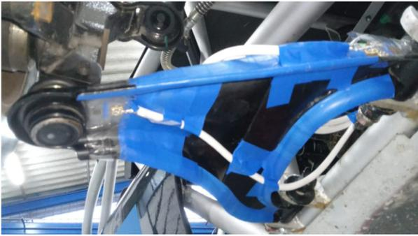
**Figura 18.** Montaje de trapecio dispuesto con las galgas extensiométricas
