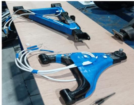
**Figura 17.** Conexiones instaladas en los trapecios oscilantes para su integración con el sistema DAQ
