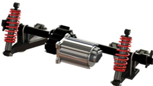
**Figura 6.** Modelo CAD de suspensión posterior Eje Rígido
