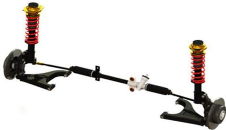
**Figura 5.** Modelo CAD de suspensión delantera McPherson
