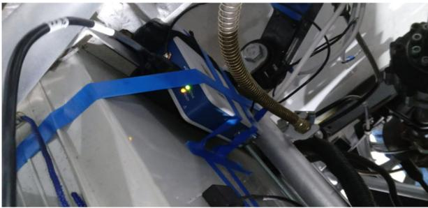
**Figura 19.** Montaje de tarjeta de adquisición NI 9219 DAQ
