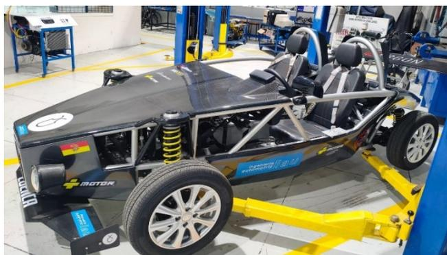
**Figura 1.** Vehículo eléctrico manufacturado biplaza
