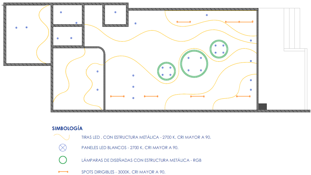
Imagen 23. Planta de iluminación.
