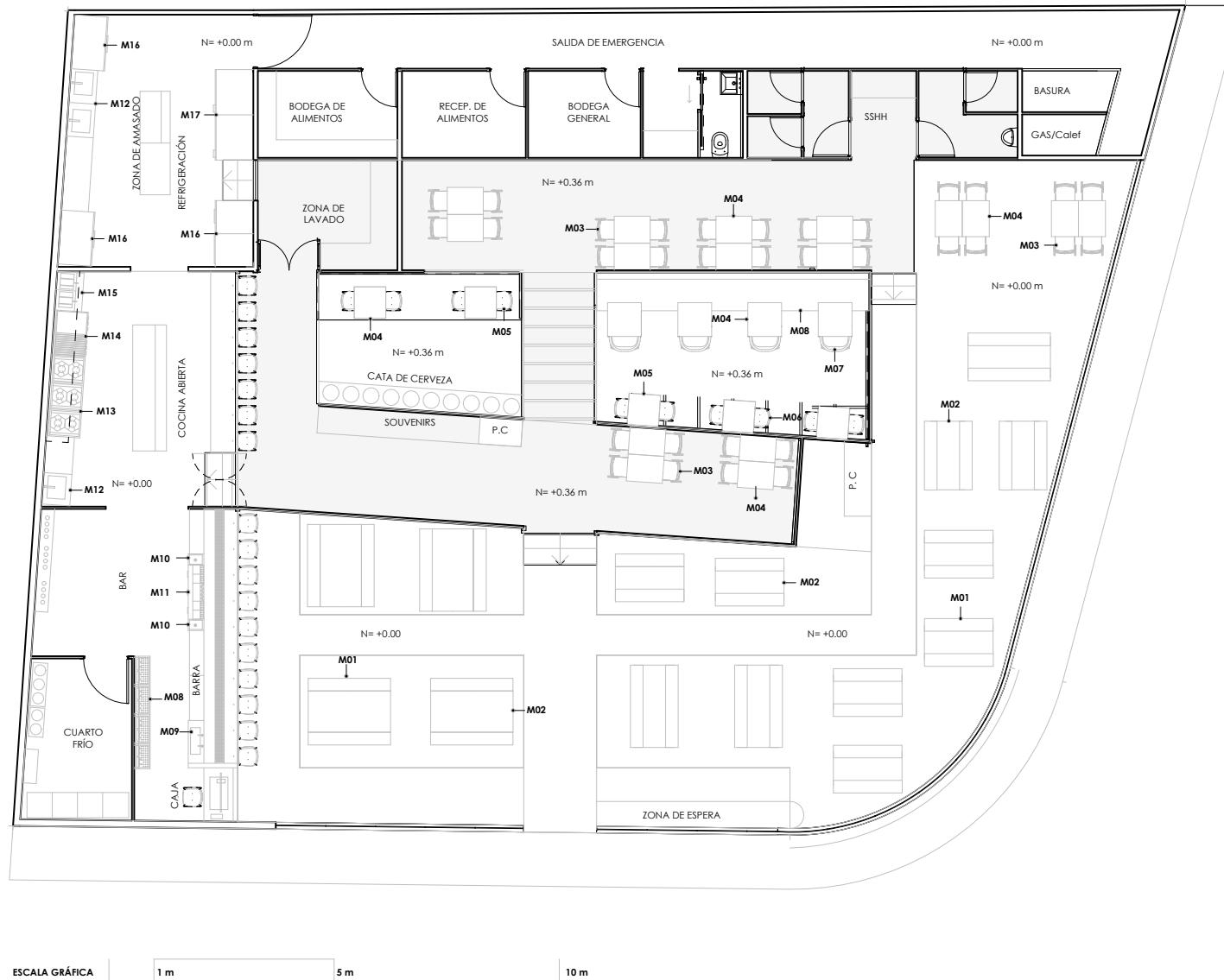
Figura 75. Planta de mobiliario
