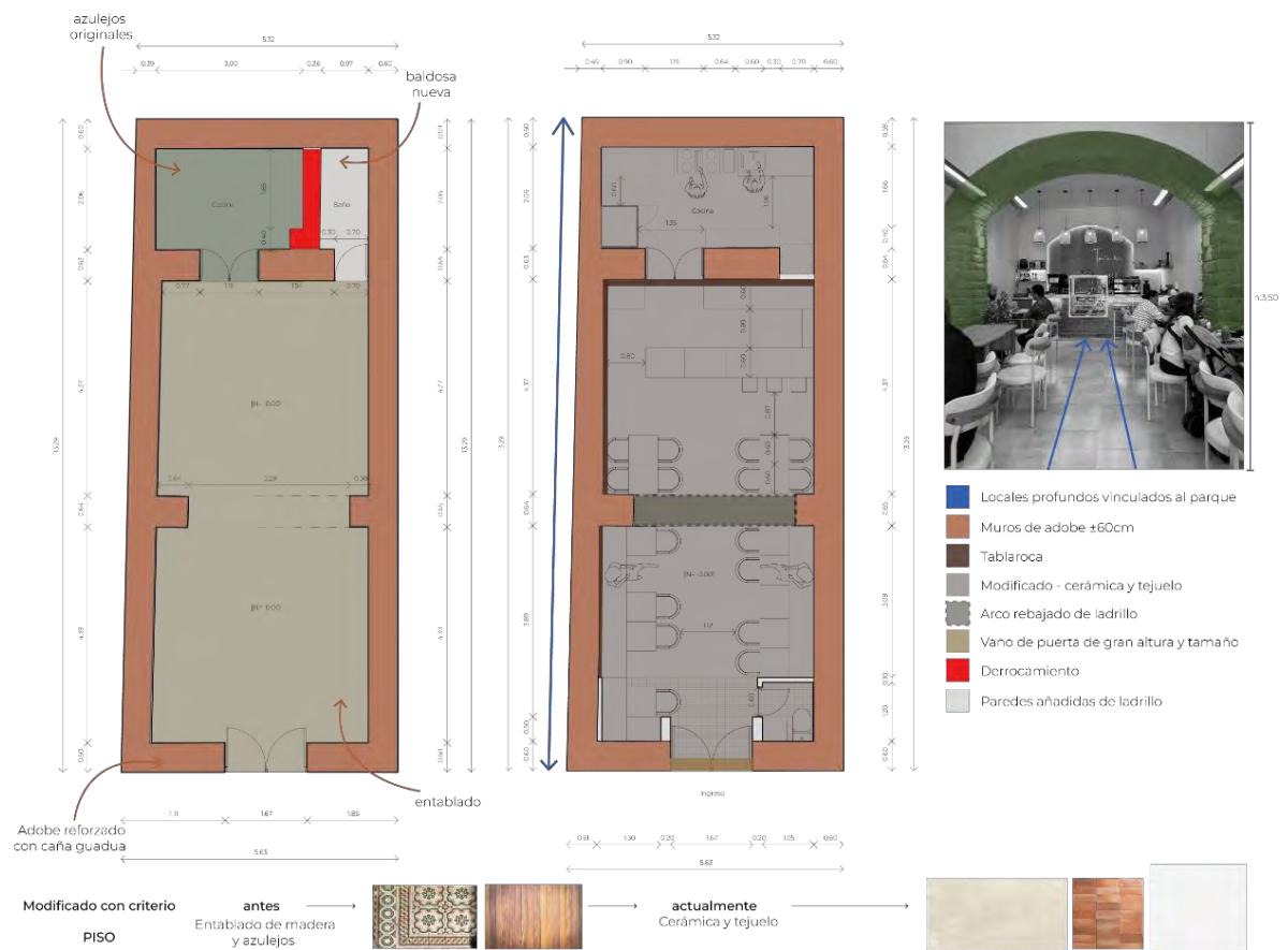
Figura 7: Análisis de elementos patrimoniales y restauraciones en el espacio actual de Tinticoos
