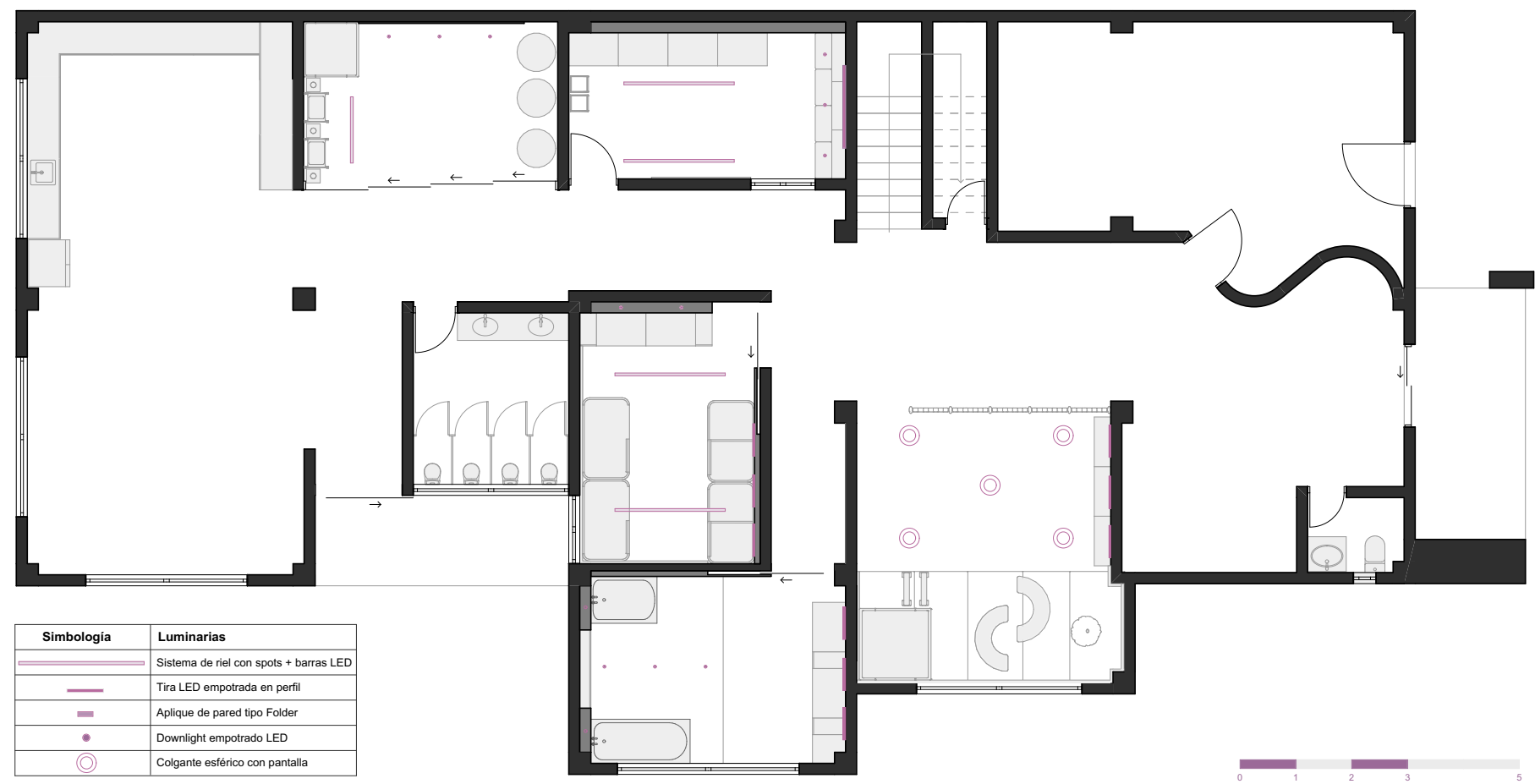
Fig. 61. Planta Baja - Ubicación de luminarias
