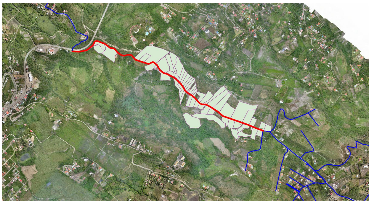
Figura 15. Tramo de tubería monitoreada para el registro de consumo nocturno y ubicación de usuarios del tramo.
