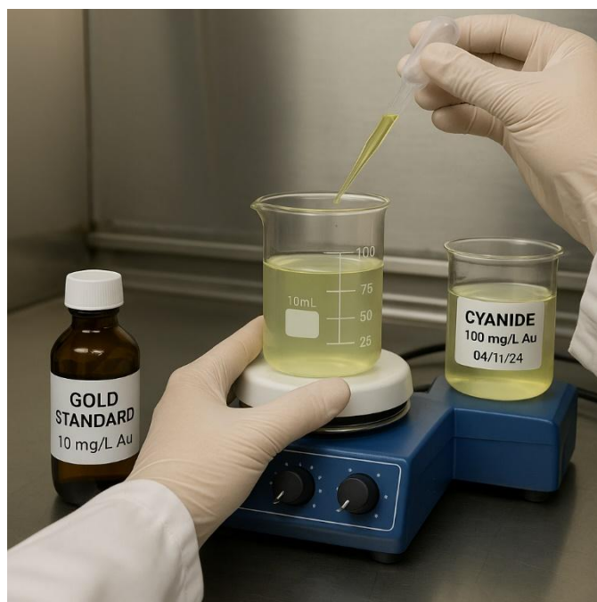
Figura 6. Adición de Au a la solución cianurada y homogeneización.
