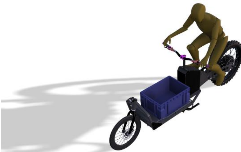
Anexo 34. Bicicleta de carga del prototipo 1 con un contenedor comercial estándar.
