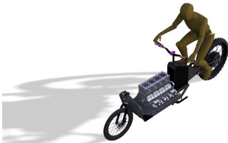
Anexo 33. Bicicleta de carga del prototipo 1 transportando un bloque motor.
