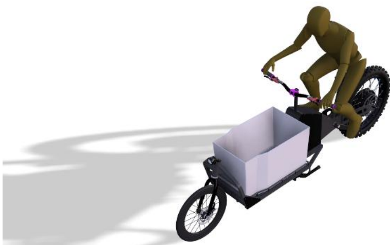
Anexo 32. Bicicleta de carga del prototipo 1 con un contenedor especial ajustado a su estructura.
