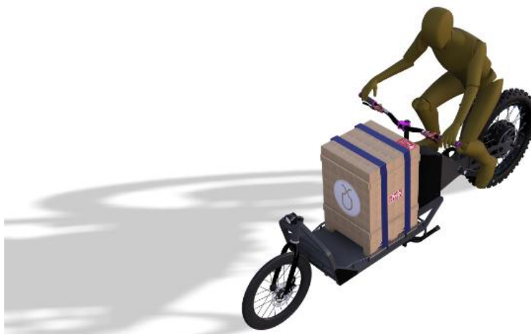
Anexo 35. Bicicleta de carga del prototipo 1 transportando una caja asegurada con cintas de sujeción.
