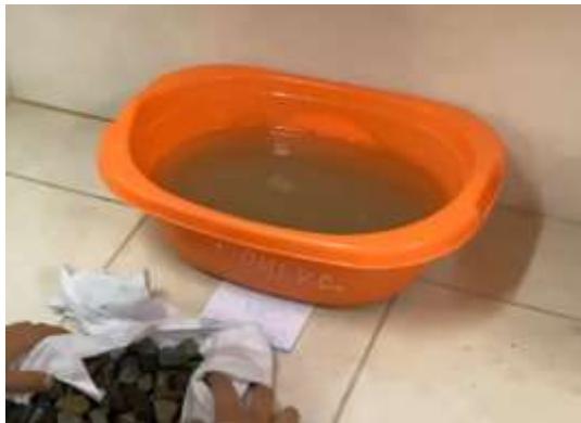
Figura 18: Muestra sumergida en agua durante 24 horas.
