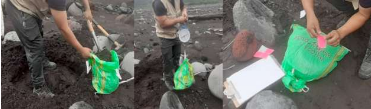
Figura 11: Procedimiento de recolección en campo de muestras de material pétreo.
