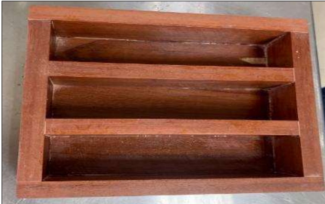
Figura 31: Moldes para método Ultra Acelerado de prismas de hormigón
