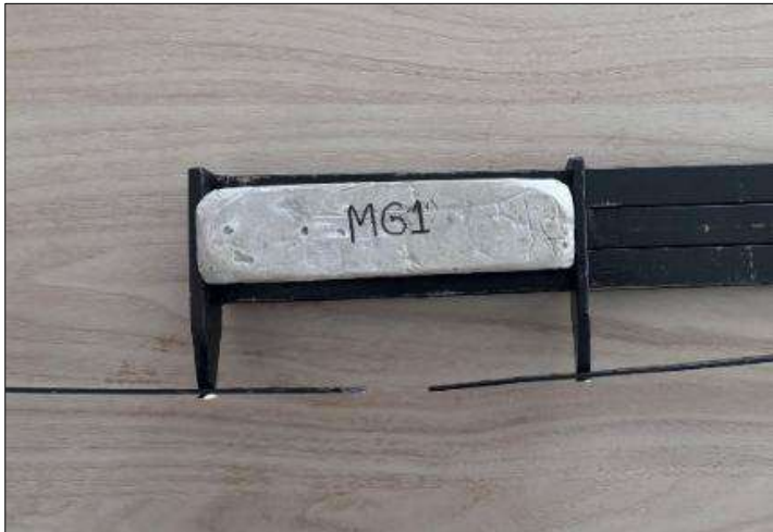
Figura 30 Medición de las barras
