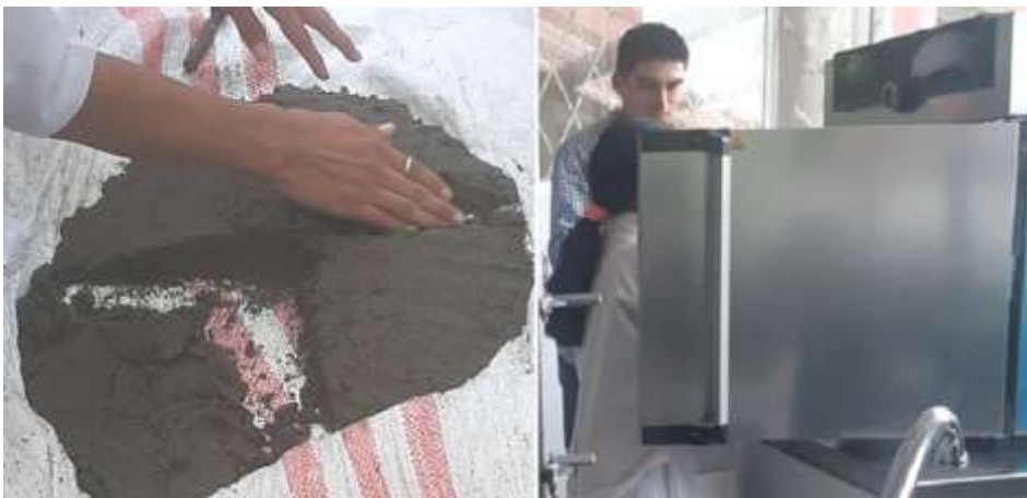
Figura 24: Muestra representativa de material y secado en horno a 110 °
