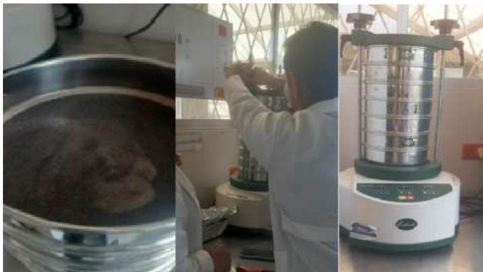
Figura 13: Realización del ensayo granulométrico.
