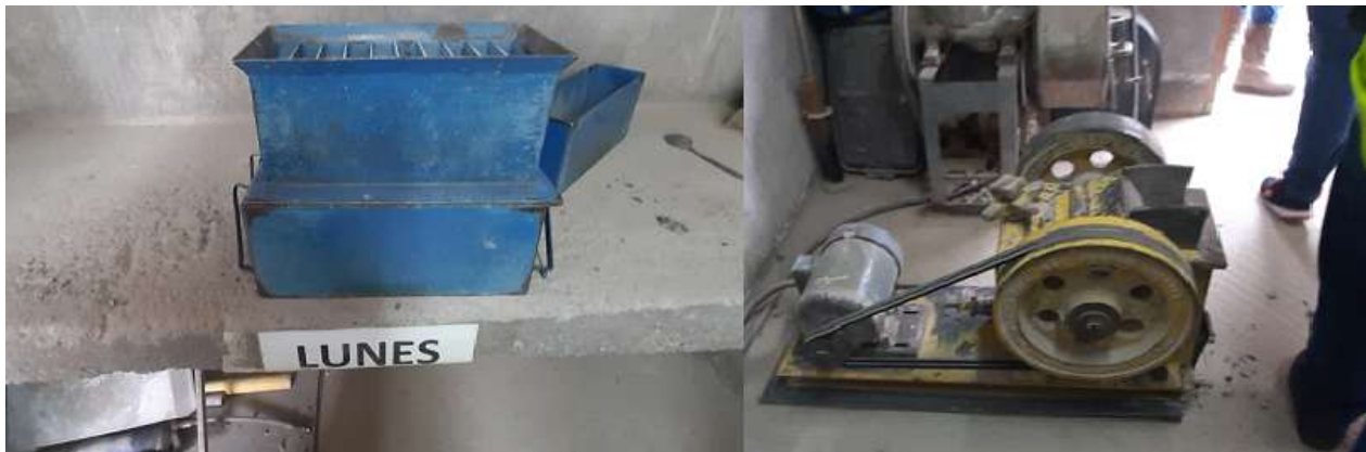
Figura 25: Cuarteo y la trituración primaria realizadas para la preparación de las muestras
