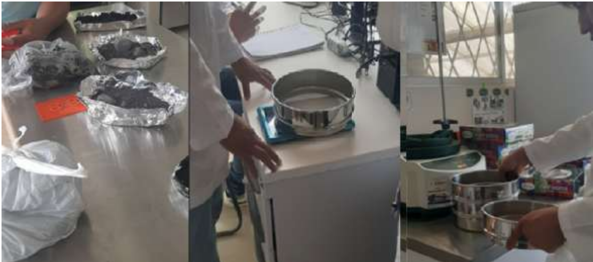
Figura 12: Preparación del material y equipo para realizar el ensayo granulométrico.
