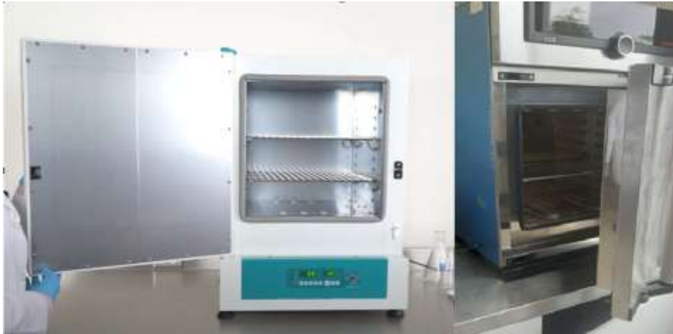
Figura 17: Secado de la muestra hasta masa constante
