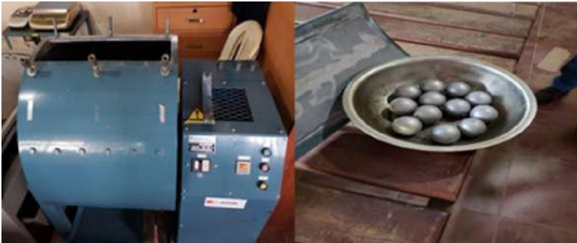
Figura 9: Máquina de Los Ángeles y carga abrasiva compuesta por esferas de acero
