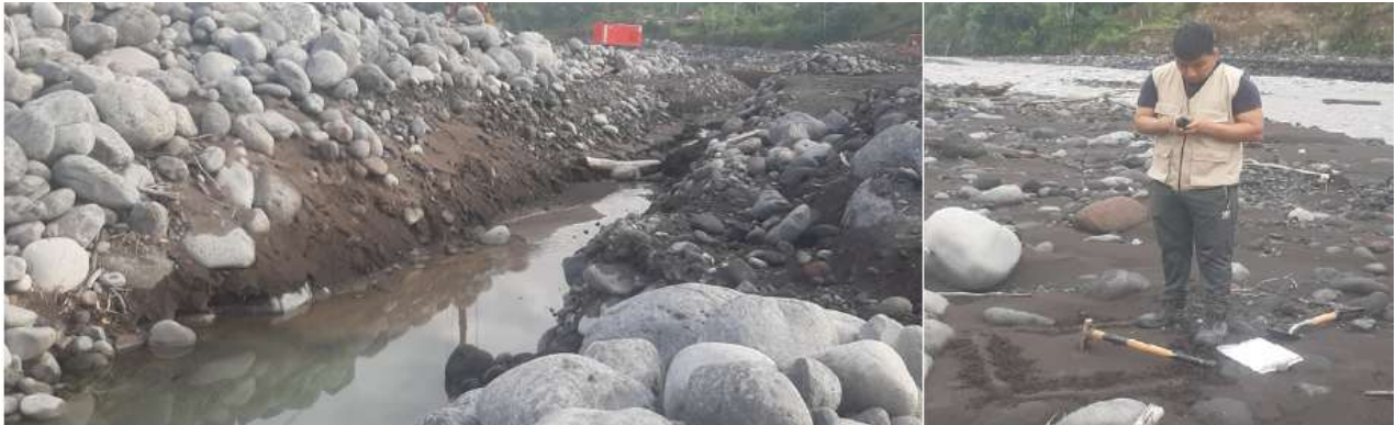
Figura 10: Recolección in situ de las muestras de material pétreo
