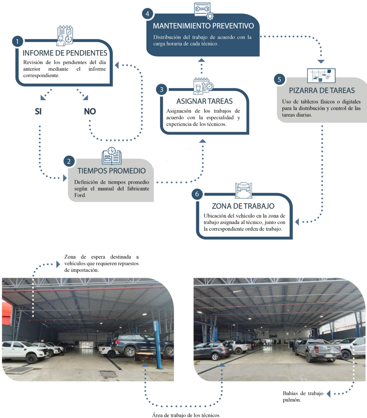
Figura 6 Diagrama de flujo del proceso de distribución del trabajo.
