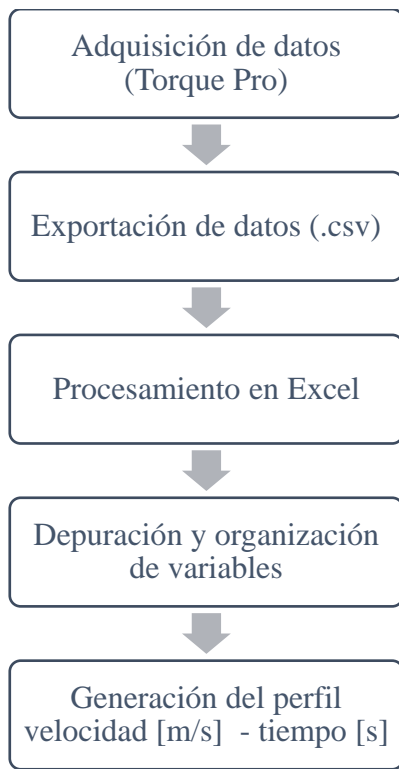
Fig. 3. Diagrama de flujo del procesamiento de datos.
