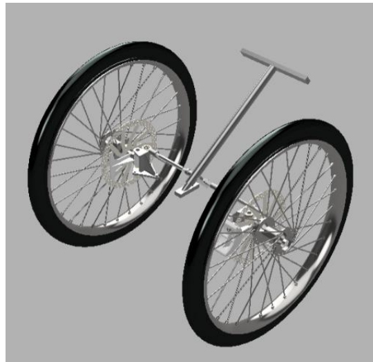
Figura 20 Primer diseño propuesto para el sistema de dirección
