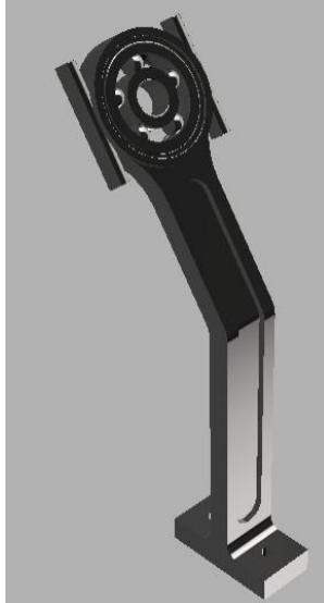
Figura 27 Diseño propuesto para el soporte de la columna de dirección
