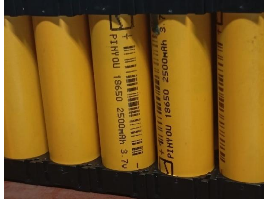
Fig 8: Celdas de litio-ion colocada en los elementos de interconexión
