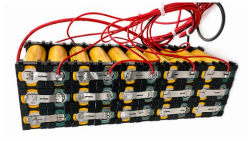
Fig 9: Platinas de níquel soldadas para configuración en serie
