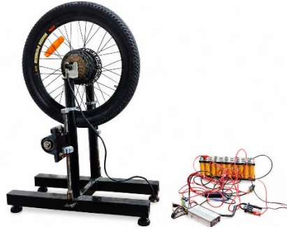
Fig 14: Conexión batería al motor en la bancada
