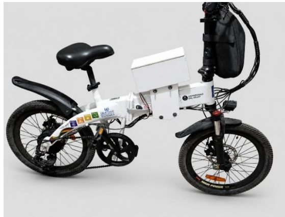
Fig 16: Alojamiento de la batería en la bicicleta
