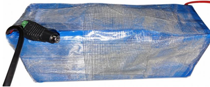
Fig 13: Aislamiento eléctrico de la batería
