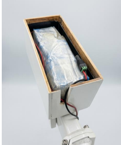
Fig 18: Batería montada en el alojamiento en la bicicleta
