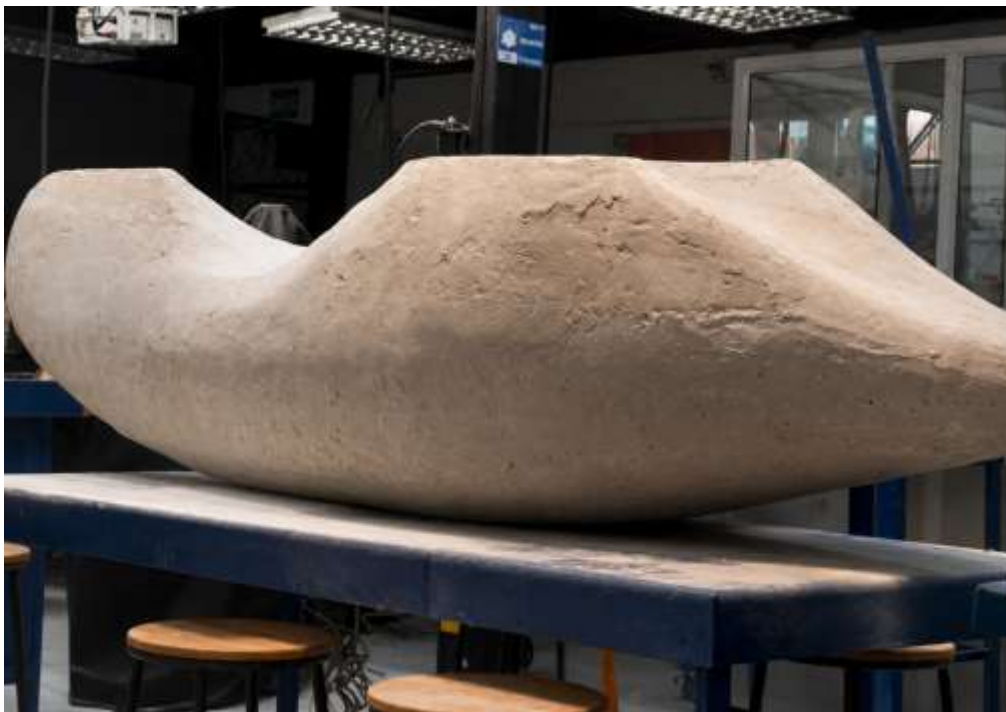
Fig. 16 Masillado del molde
