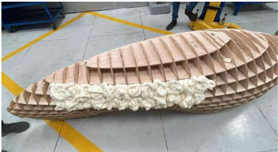
Fig. 13 Colocación de Espuma
