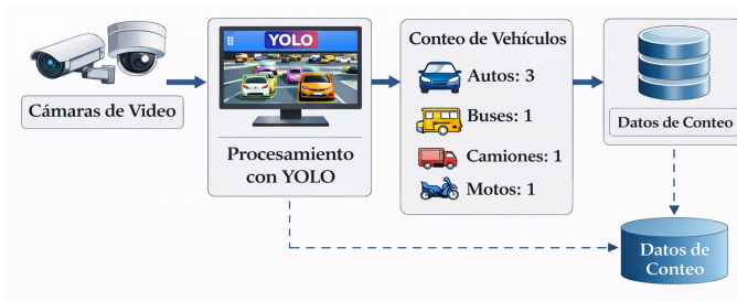
Fig. 6. Proceso de detección y conteo vehicular mediante YOLOv8.
