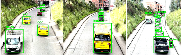
Fig. 5. Tipos de vehículos considerados en el sistema de detección vehicular mediante YOLOv8.
