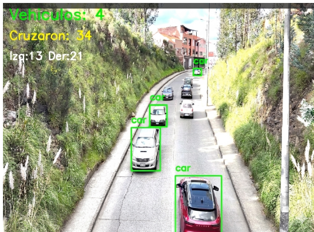
Fig. 10. Detección de vehículos mediante YOLO en el sector del Arco de Yanuncay la avenida Loja de la ciudad de Cuenca, Ecuador.
