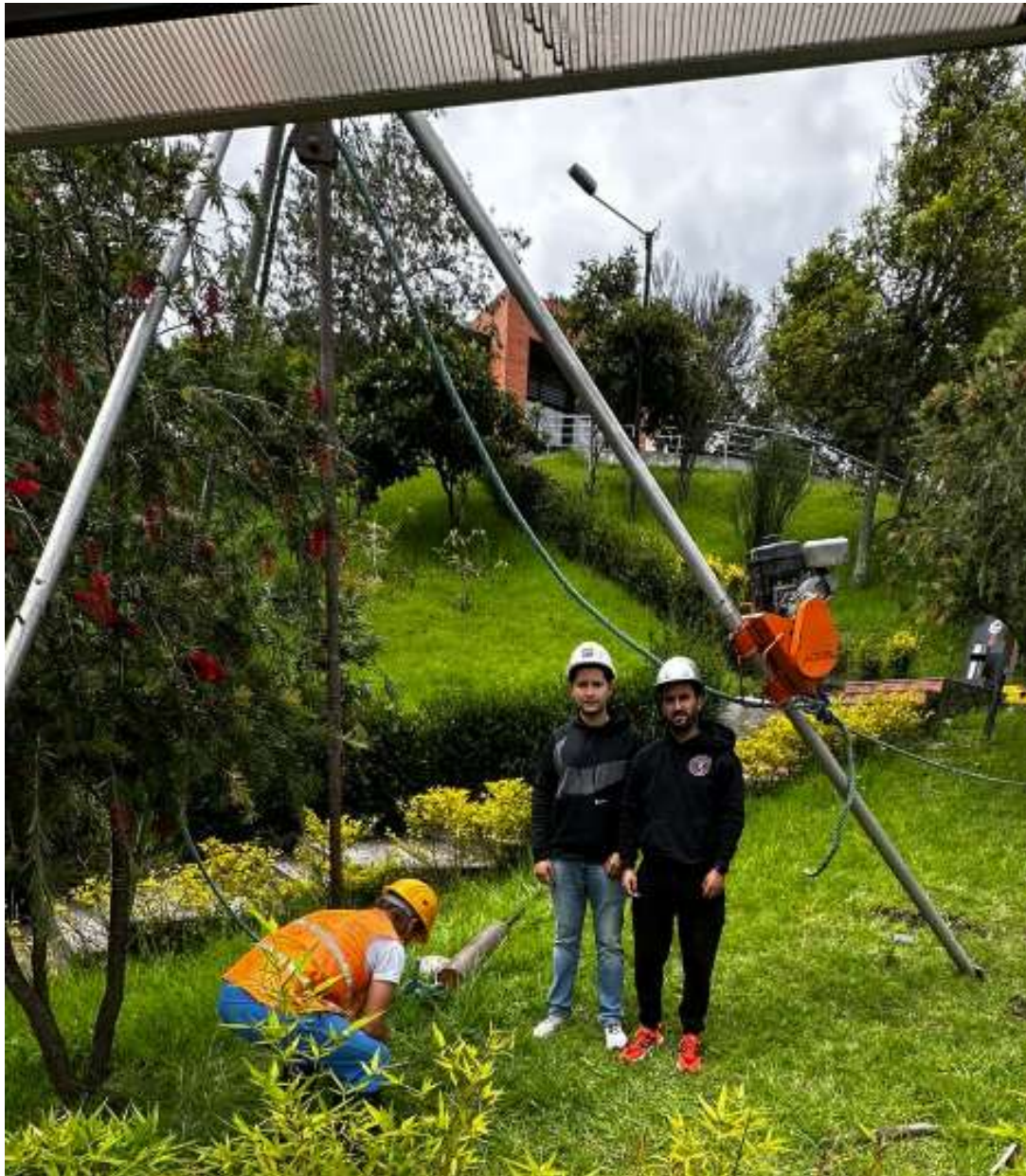
Figura 2-9: Ensayo SPT, punto 6.
