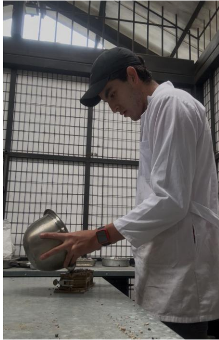
Figure 20: Elaboración de las Probetas Cúbicas
