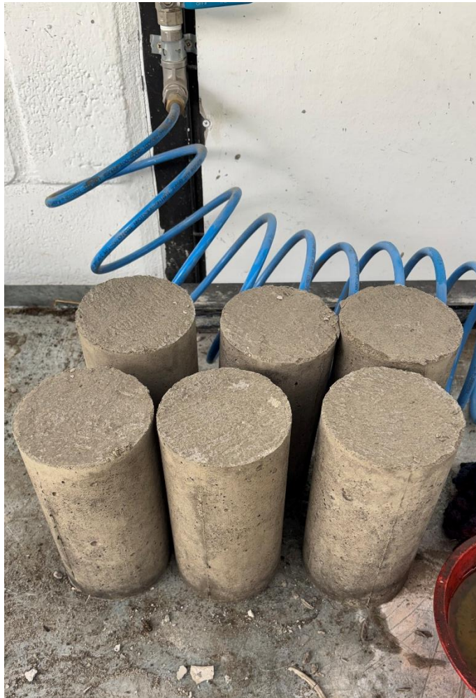
Figure 18: Probetas Cilíndricas para romper a los 14 días
