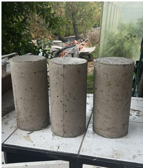
Figure 17: Probetas Cilíndricas para romper a los 7 días
