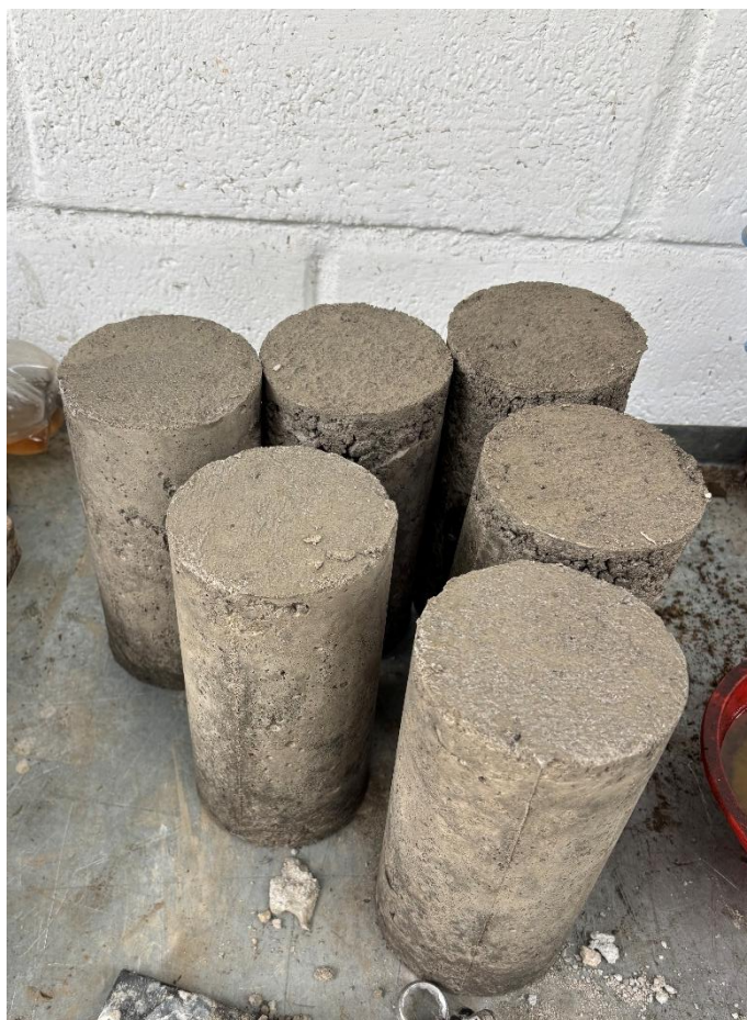
Figure 19: Probetas Cilíndricas para romper a los 28 días
