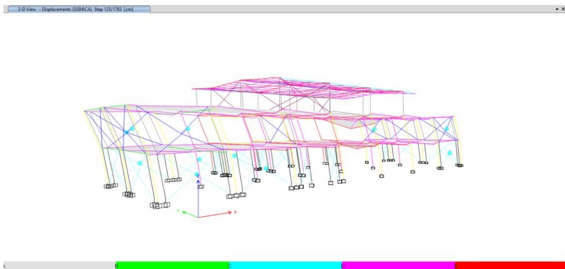
Figura 3-15: Rótulas plásticas al momento de llegar al punto de desempeño T_r=2500 años, sentido X
