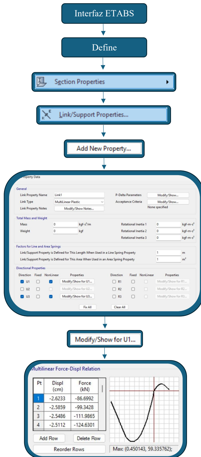
Figura 2-20. Diagrama de flujo para la modelación de los elementos tipo link
