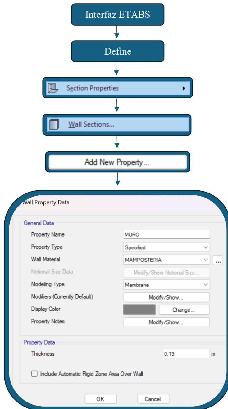
Figura 2-23. Diagrama de flujo para definir la sección del elemento
