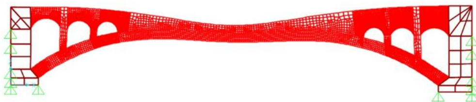
Figura 6.2 Forma modal del modelo numérico del Puente del Centenario obtenida mediante análisis modal en SAP2000.
