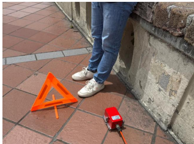
Figura 7.3: Acelerómetro utilizado para la medición de vibraciones en el Puente del Centenario.
