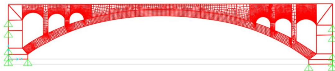
Figura 4.2: Modelo tridimensional del Puente del Centenario discretizado mediante elementos sólidos en SAP2000.
