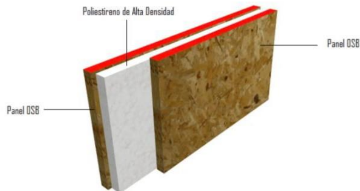
Figura 1-3: Composición de Panel SIP
