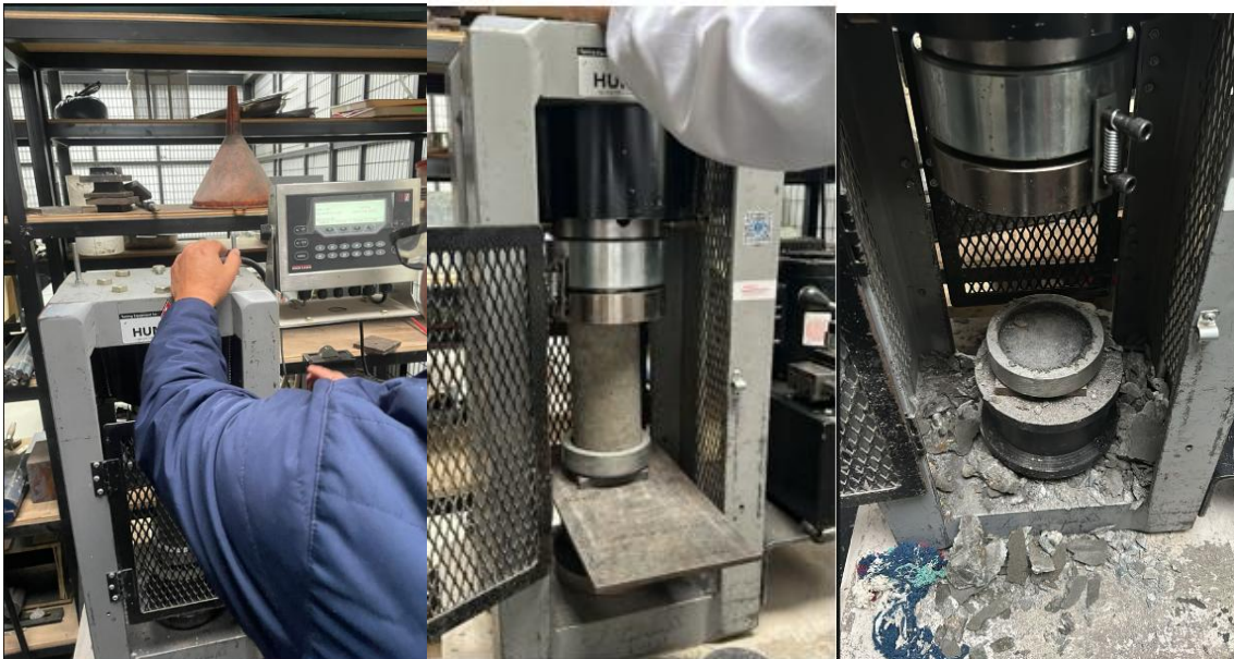
Figure 10 Prensa hidráulica con cilindro de hormigón previa rotura
