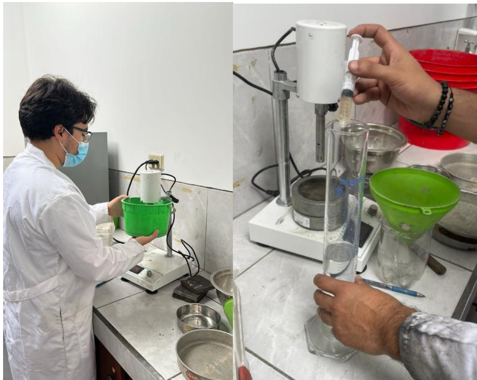
Figure 8 Proceso de mezclado homogeneizador (ADITIVO DESPUES)
