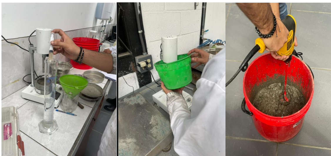
Figure 5 Proceso de mezclado homogeneizador (ADITIVO ANTES)
