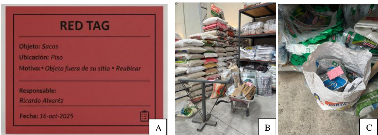
A. Tarjeta Roja para 5S. B-C. Aplicación de Tarjetas en Bodega
