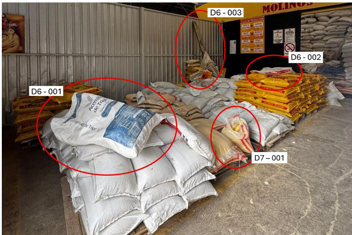
Ilustración 7: Identificación de desperdicios en el área de almacenamiento producto terminado
