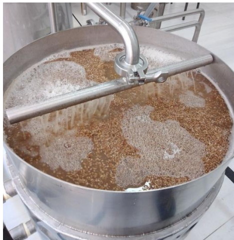
Figura 2.6. Recirculado después de la maceración.
