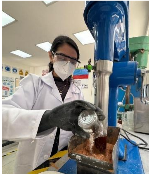
Figura 33. Ajuste del pH con caolín
