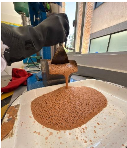
Figura 36. Recolección de la espuma con los óxidos de hierro
