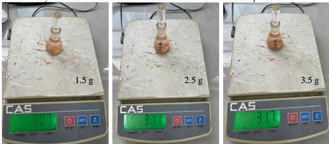
Figura 27. Ensayo de determinación de densidad mediante el método del picnómetro
