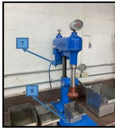
Figura 14. Celda de flotación Denver con sus respectivas partes
