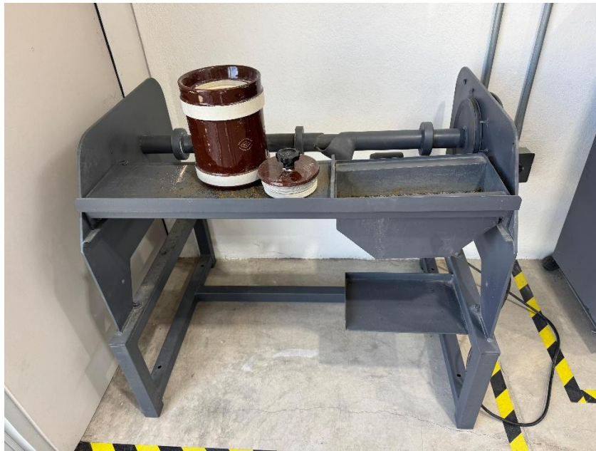
Figura 23. Molino de bolas de cerámica utilizado en el proceso de molienda
