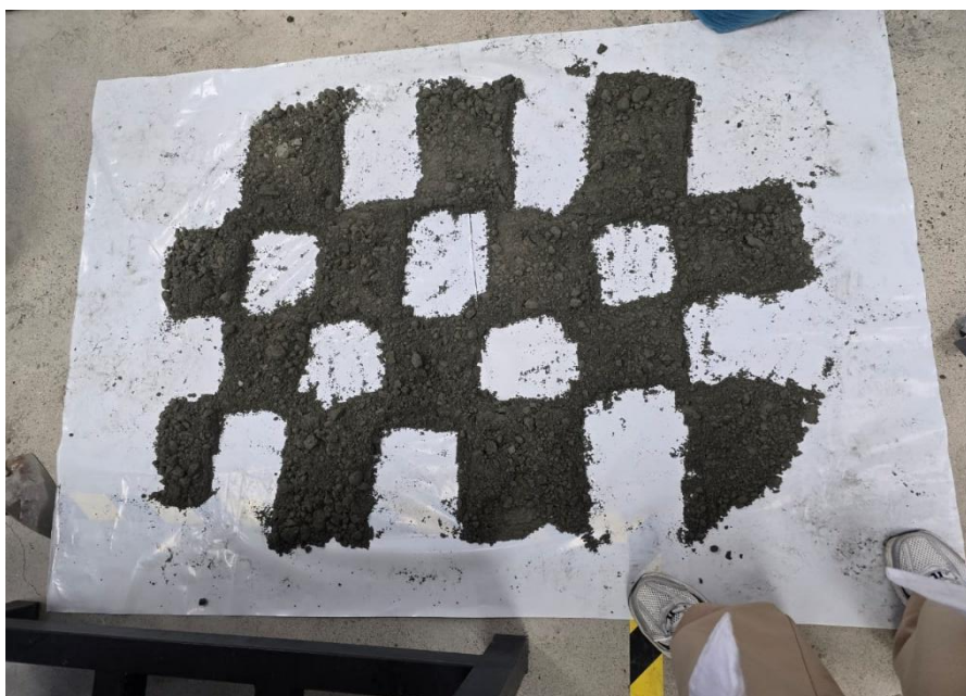
Figura 6. Proceso de cuarteo mediante el método de torta
