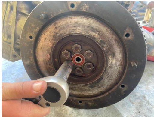
Figura 40. Apriete de los pernos del volante de inercia.
