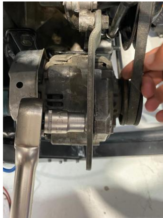
Figura 43. Instalación del alternador.
