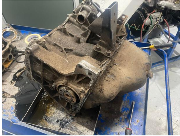
Figura 9. Aflojada de los pernos del cárter.
