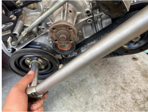
Figura 39. Apriete del perno de la polea de la polea del cigüeñal.
