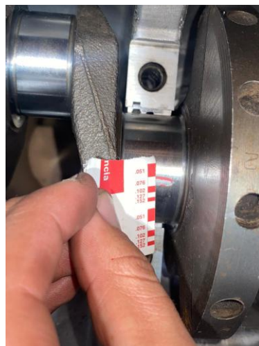
Figura 24. Prueba de plastigauge de las bancadas 3 del cigüeñal.
