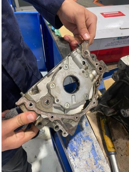
Figura 14. Bomba de aceite desmontada.
