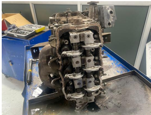
Figura 6. Aflojada de pernos del cabezote.
