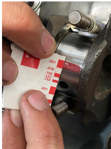
Figura 26. Prueba de plastigauge de la muñequilla de biela 1.
