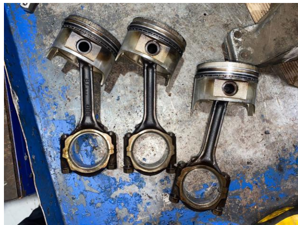
Figura 12. Desmontaje de los sombreretes de biela.
