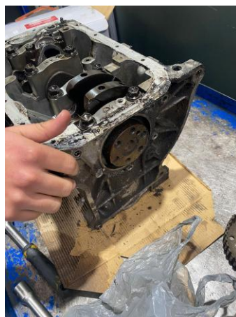
Figura 13. Tapa del retenedor del cigüeñal
