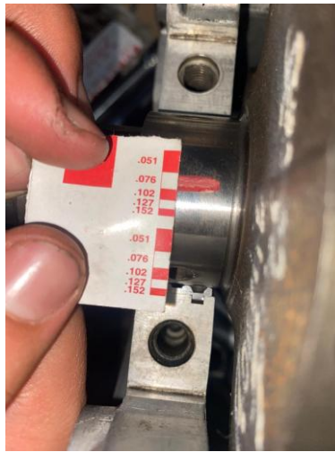
Figura 23. Prueba de plastigauge de las bancadas 2 del cigüeñal.
