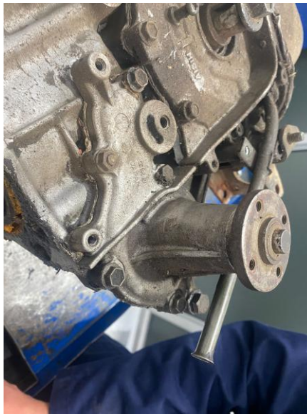
Figura 8. Bomba de agua antes del desmontaje.
