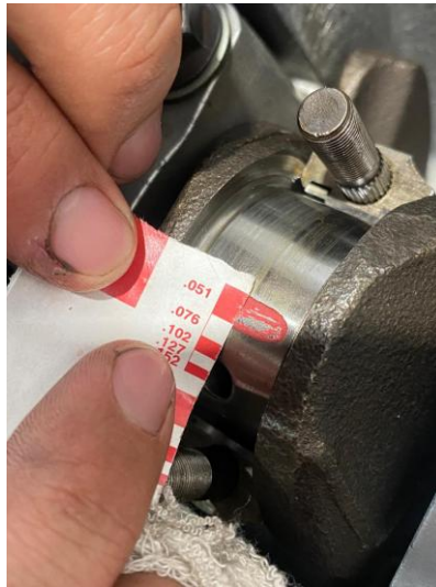
Figura 28. Prueba de plastigauge de la muñequilla de biela 3.
