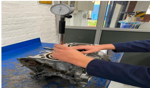
Figura 19. Medición de conicidad y ovalización de los cilindros.
