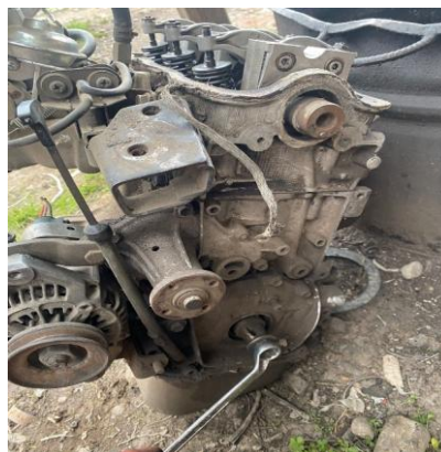
Figura 3. Comprobación para verificar si el motor no está trabado.
