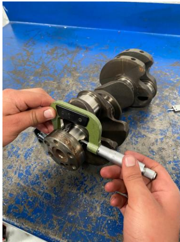
Figura 20. Medición de conicidad y ovalización de las bancadas del cigüeñal.
