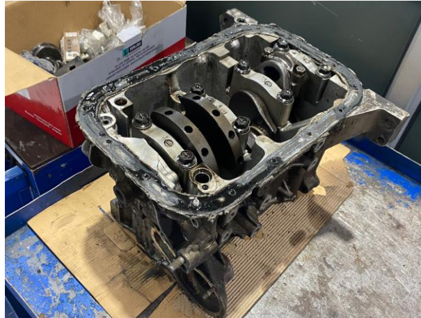
Figura 11. Aflojada de los pernos de bancada del cigüeñal.
