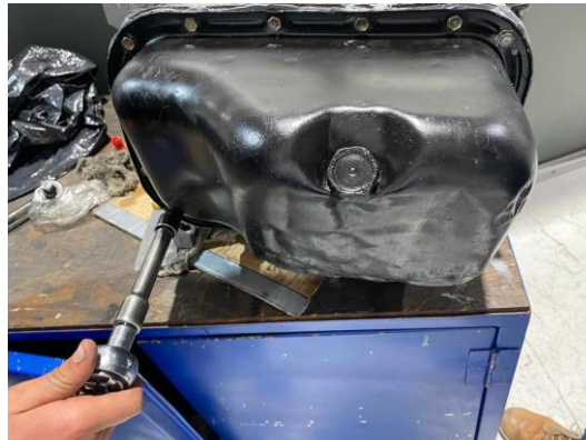
Figura 35. Instalación del cárter del motor.
