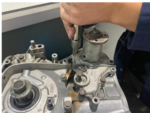
Figura 31. Bomba de agua.
