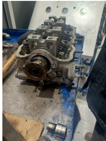
Figura 17. Desmontaje del árbol de levas.
