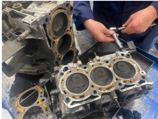
Figura 7. Desmontaje de cabezote.
