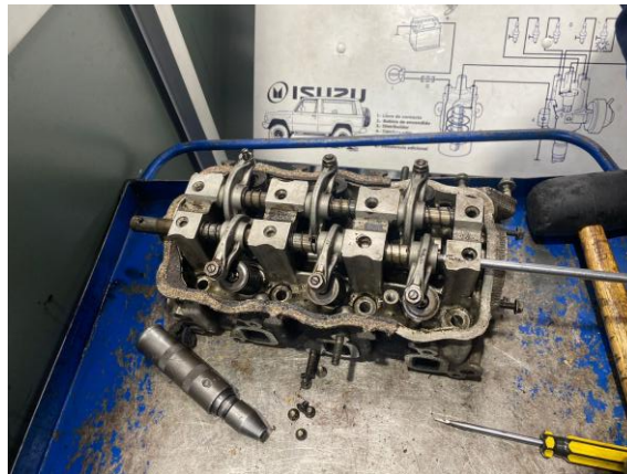
Figura 15. Aflojada de los tornillos que sujetan los ejes de balancines.
