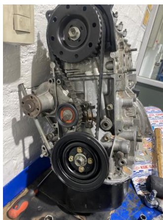
Figura 36. Sincronización del motor.
