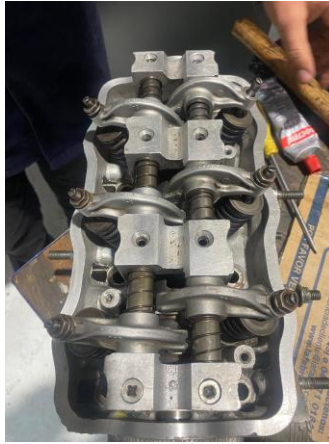
Figura 32. Armado del cabezote.
