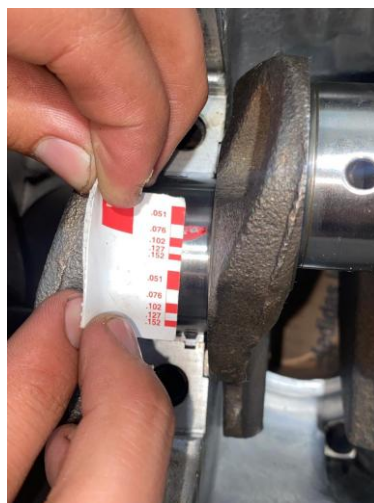
Figura 24. Prueba de plastigauge de las bancadas 3 del cigüeñal.
