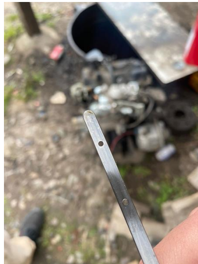
Figura 3. Comprobación para verificar si el motor no está trabado.
