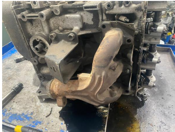
Figura 5. Múltiple de escape en desmontaje.
