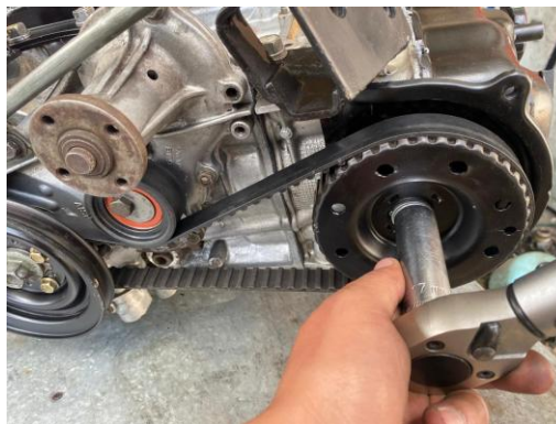
Figura 38. Apriete del perno de la polea del árbol de levas.
