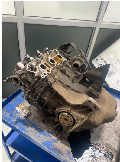
Figura 4. Desmontaje del múltiple de admisión.
