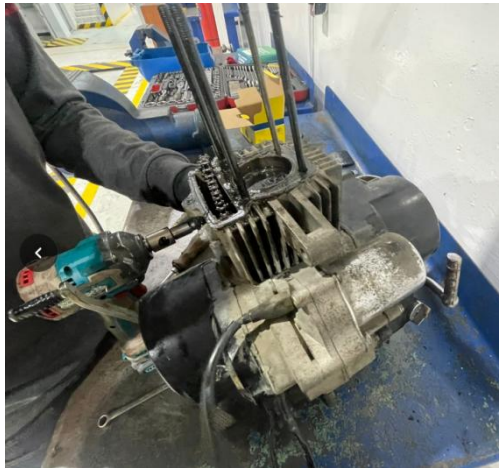
Figura 8. Desmontado de palanca de cambios y tapa lateral
