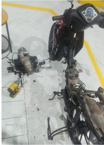
Figura 4. Desmontaje de motor
