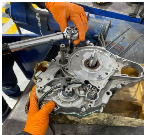
Figura 24. Montaje de las carcasas de motor con torquímetro
