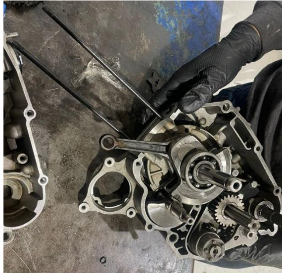
Figura 20. Montaje de caja de cambios y cigüeñal
