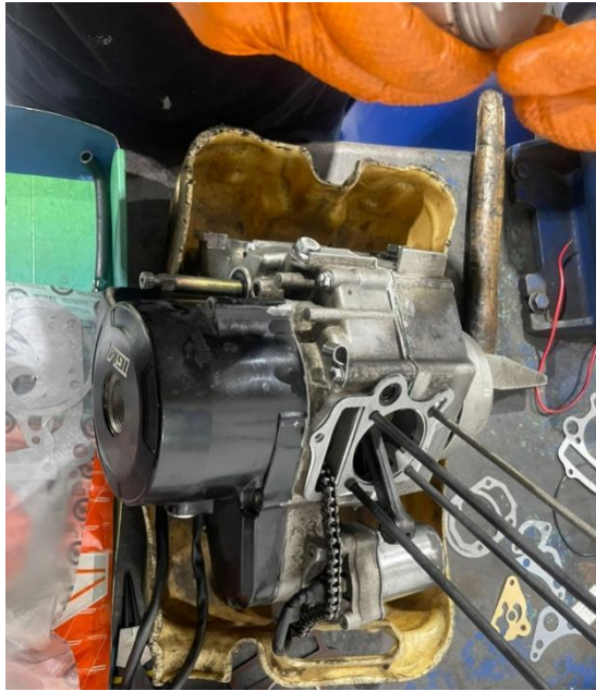
Figura 26. Montaje del cilindro
