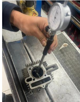
Figura 15. Medición del cilindro con alexómetro
