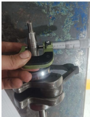
Figura 18. Medición del cigüeñal
