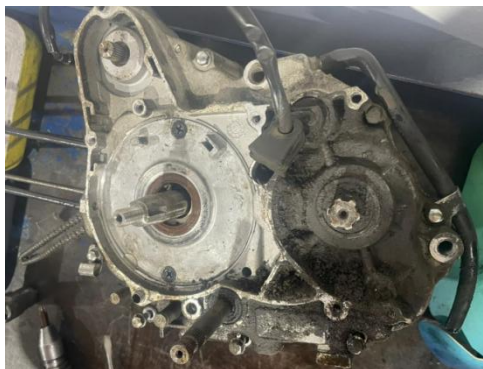
Figura 14. Tapa desarmada lado de piñón de cadena de transmisión
