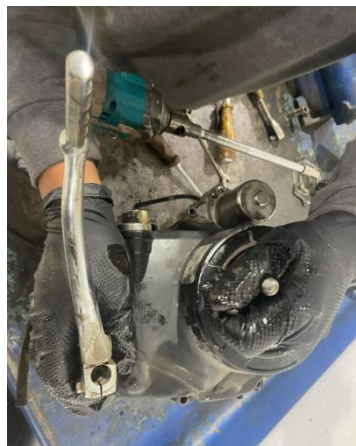
Figura 8. Desmontado de palanca de cambios y tapa lateral
