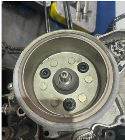
Figura 13. Desarmado de motor de arranque y volante motor
