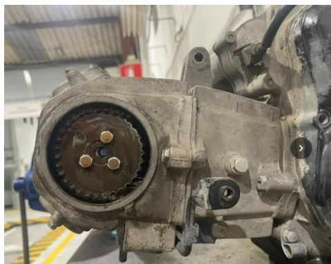
Figura 5. Desmontado cabezote y desarmado de distribución
