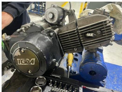
Figura 28. Montaje del motor de arranque
