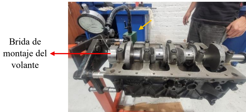
Figura 14. Medición de la holgura axial del cigüeñal.
