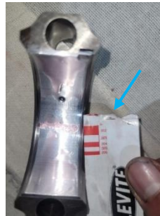
Figura 16. Verificación de la película de aceite de la muñequilla de biela.
