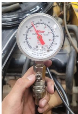
Figura 1. Medición de la presión de compresión en uno de los cilindros.
