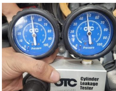
Figura 2. Medición de fugas presente en uno de los cilindros.
