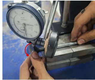
Figura 13. Medición del alabeo presente en una válvula de escape.
