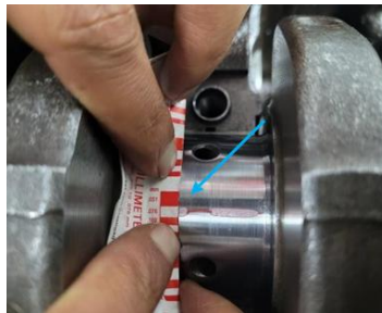
Figura 15. Verificación de la película de aceite de la bancada del cigüeñal.
