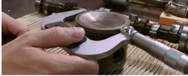
Figura 8. Medición del diámetro del pistón para comprobar el desgaste y la compatibilidad con el cilindro.
