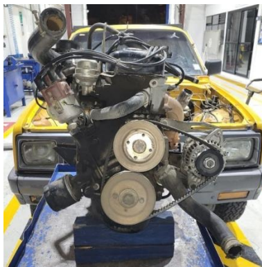
Figura 3. El motor se extrajo del vehículo utilizando una grúa hidráulica, lo que garantizó la estabilidad y la seguridad durante su extracción.
