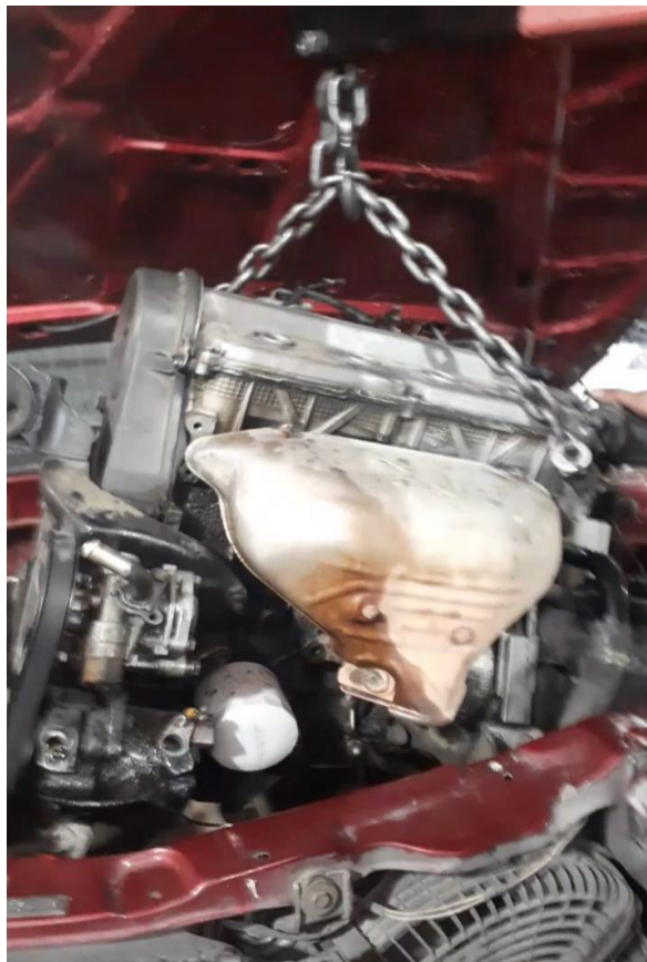
Figura 5. Desmontaje de motor con la pluma hidráulica.
