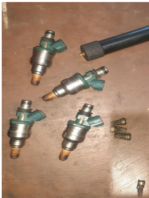
Figura 31. Proceso de lavado de inyectores.
