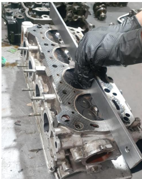
Figura 21. Comprobación de planicidad de la culata.
