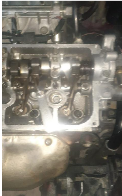
Figura 38. Calibración de válvulas.
