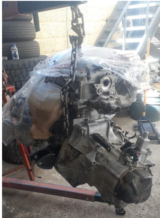
Figura 34. Motor con caja instalada y listo para su montaje.
