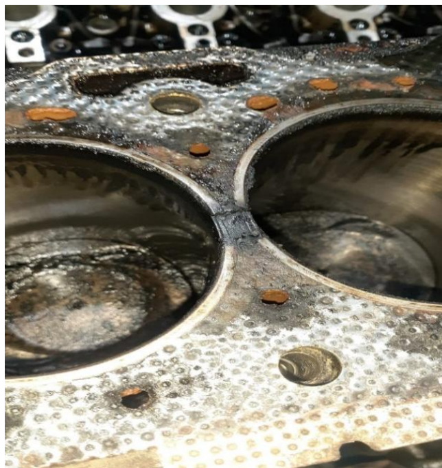
Figura 18. Empaque de culata fisurado.
