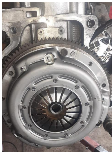
Figura 33. Instalación de embrague nuevo.
