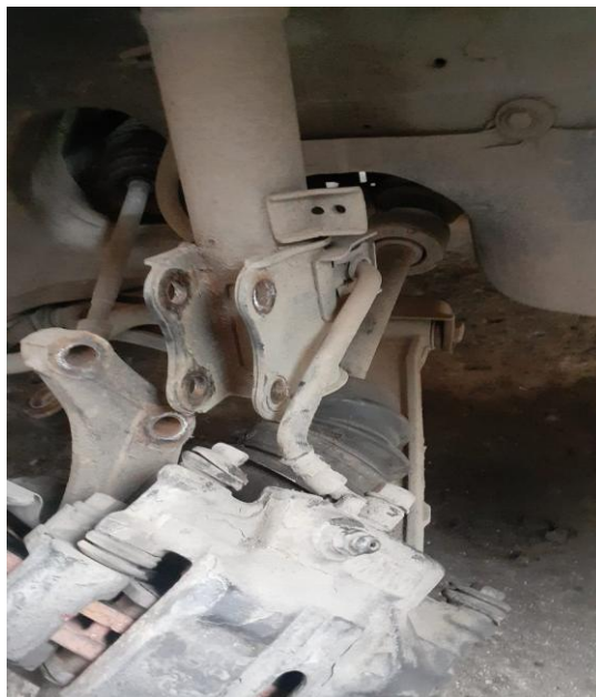
Figura 3. Desmontaje de palieres.
