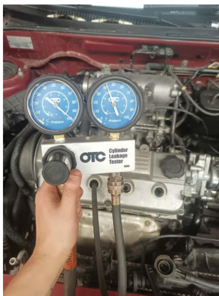
Figura 42. Comprobación de fugas.
