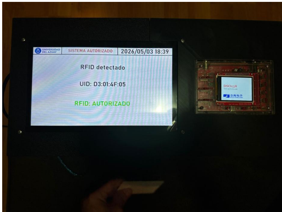
Figura 51. Sistema autorizado después de la lectura RFID en la pantalla HMI.
