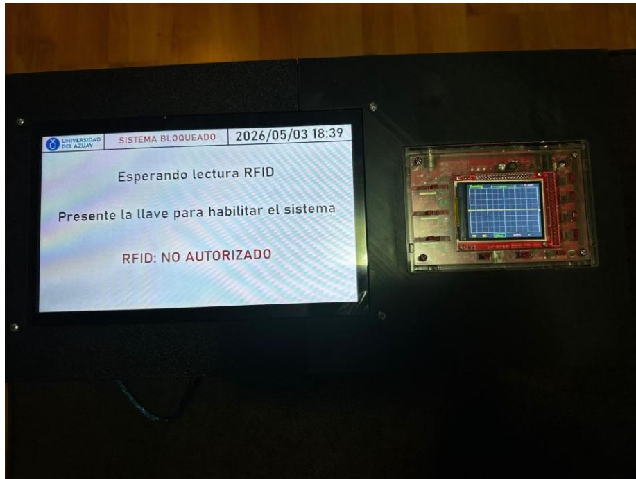
Figura 50. Sistema bloqueado en espera de lectura RFID para habilitar el banco didáctico.
