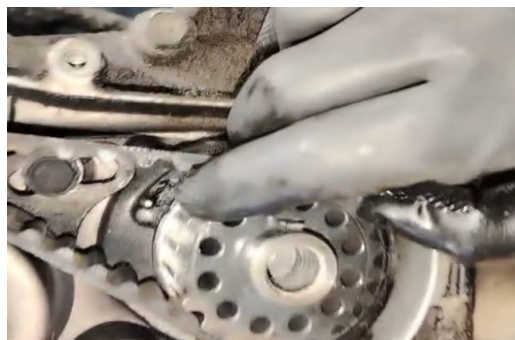
Figura 7 Marca de sincronización del bloque y piñón-cigüeña
