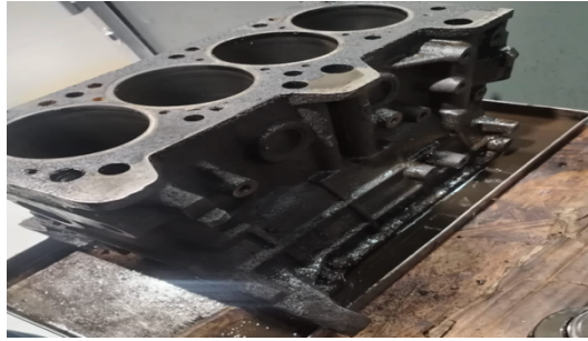
Figura 17 Limpieza del cárter
