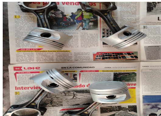
Figura 23 Pistones con sobre medida
