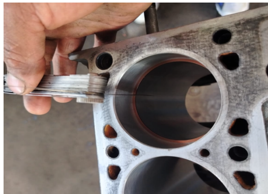
Figura 25 Luz entre puntas de rines
