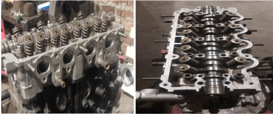
Figura 36 Proceso de armado de cabezote
