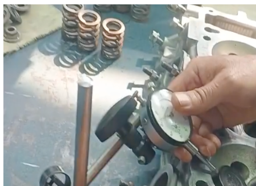
Figura 31 Vástago de válvula de admisión
