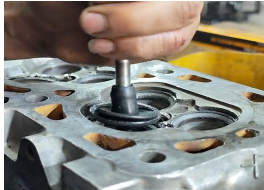
Figura 35 Proceso de asentamiento de válvulas
