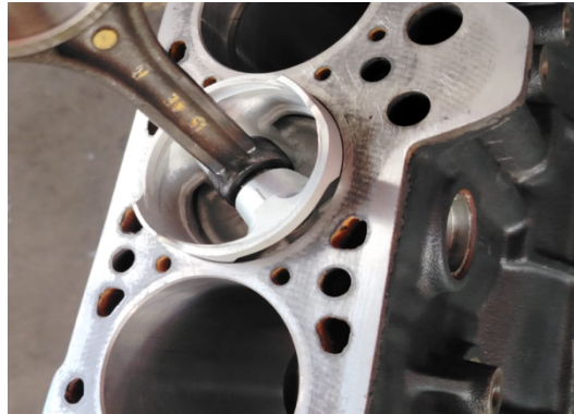
Figura 24 Luz de cilindro-pistón
