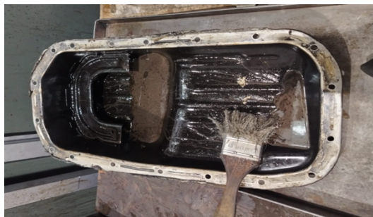
Figura 18 Limpieza de Bancadas
