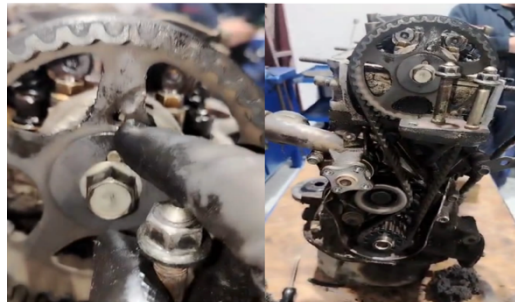
Figura 6 Marca de sincronización del cabezote
