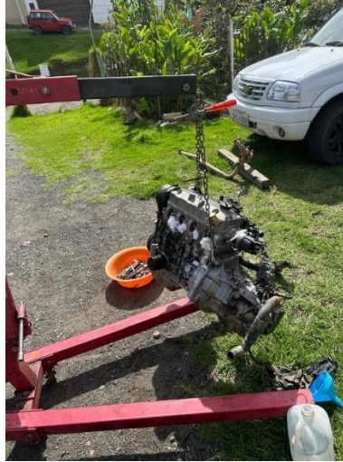
FIGURA 76. MONTAJE DE MOTOR EN PLUMA Y MONTAJE DE CAJA DE CAMBIOS
