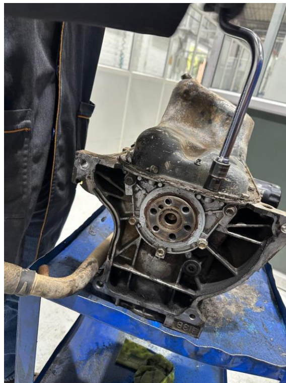
FIGURA 39. DESMONTAJE DE CÁRTER
