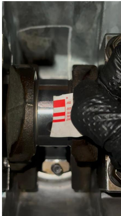
FIGURA 62. MEDICIÓN EN MUÑONES DE BIELAS
