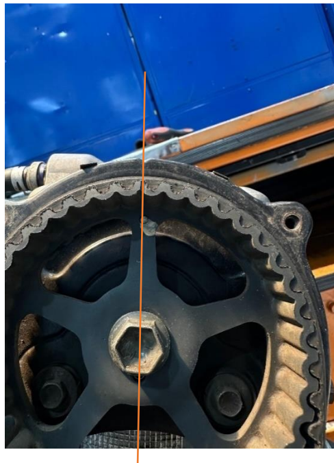
FIGURA 25. REFERENCIA DE PUESTA A PUNTO EN ÁRBOL DE LEVAS
