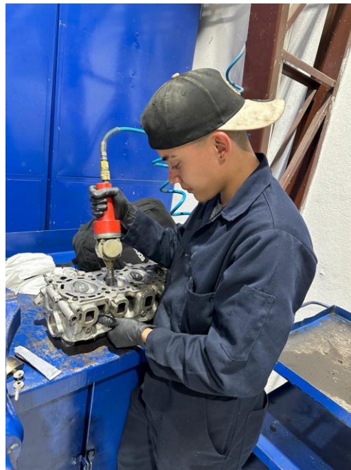
FIGURA 52. ASENTAMIENTO DE VÁLVULAS
