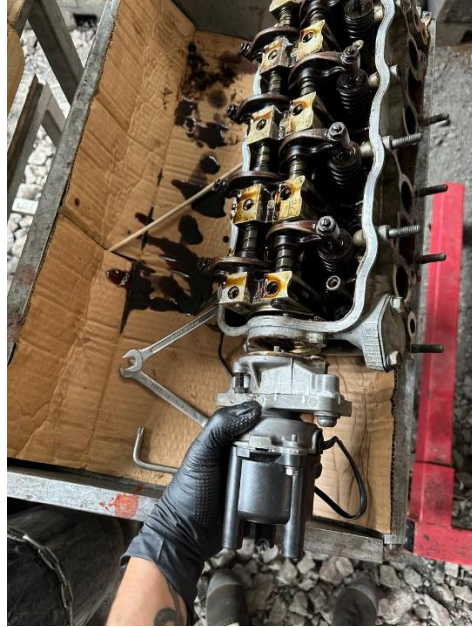
FIGURA 34. DESMONTAJE DE DISTRIBUIDOR
