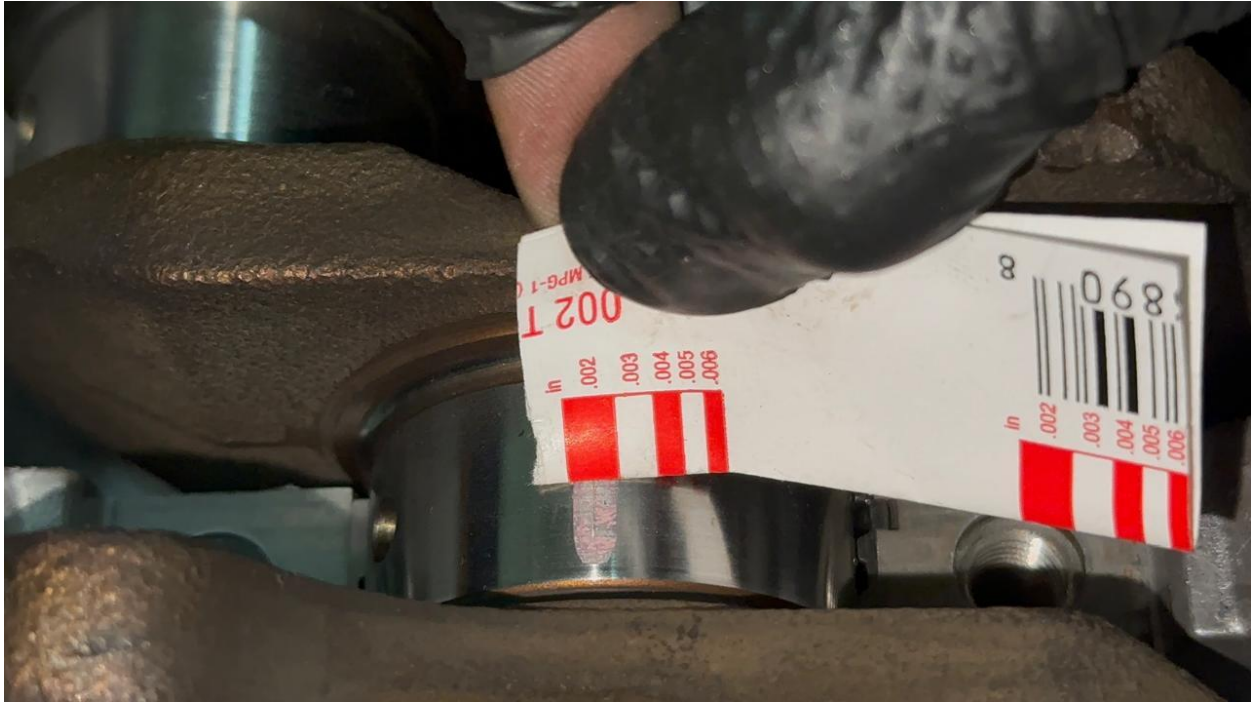
FIGURA 61. MEDICIÓN DE PLASTIGAUGE
