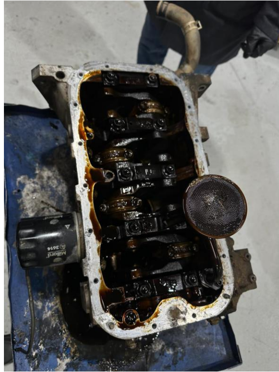
FIGURA 41. DESMONTAJE DE SOMBRETEROS DE BIELA Y SOMBRETEROS DE BANCADA
