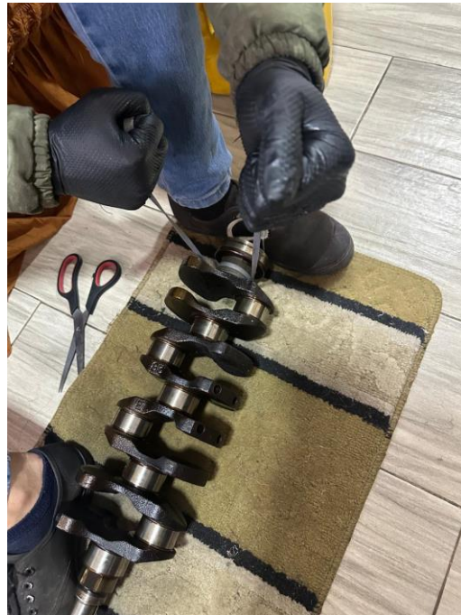
FIGURA 56. PULIDO DE CIGÜEÑAL
