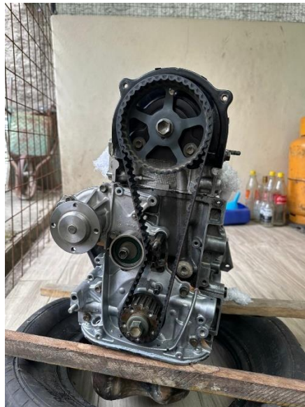
FIGURA 74. COLOCACIÓN DE BANDA DE DISTRIBUCIÓN
