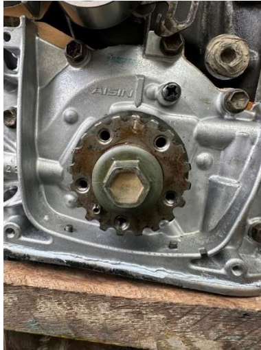
FIGURA 73. ALINEACIÓN PIÑÓN CIGÜEÑAL
