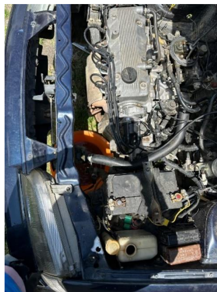
FIGURA 14. DESMONTAJE DE RADIADOR Y LÍQUIDO REFRIGERANTE
