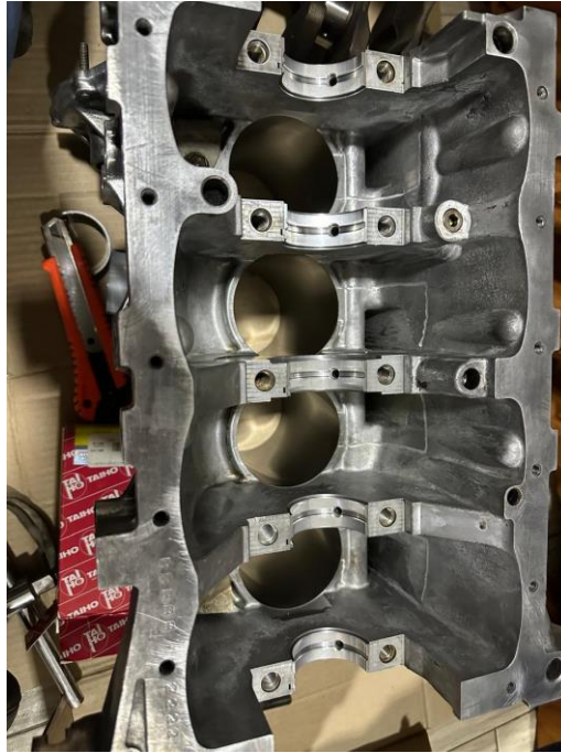
FIGURA 58. COLOCACIÓN DE COJINETES
