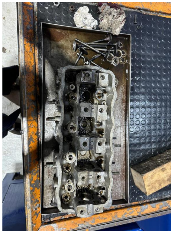
FIGURA 49. LAVADO DE CABEZOTE
