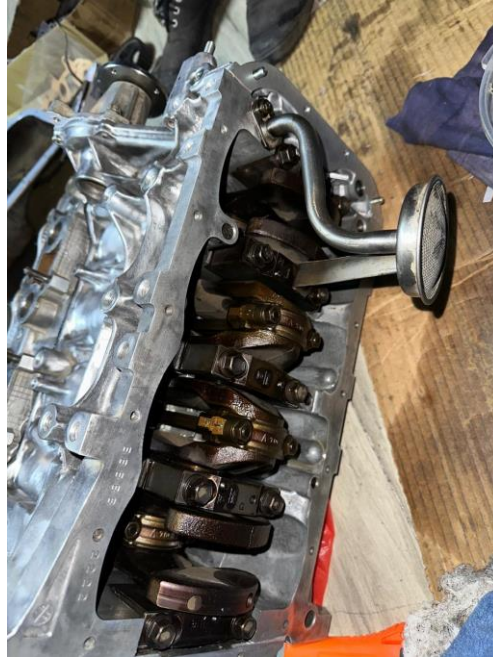
FIGURA 70. COLOCACIÓN DE SEDASO
