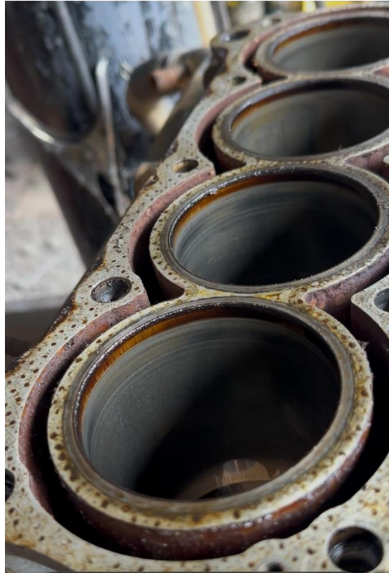
FIGURA 43. EVIDENCIA DE CEJA EN CILINDROS
