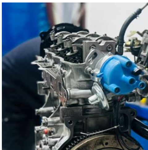
Figura 40 Colocación del Distribuidor
