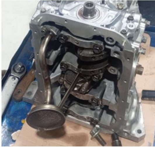
Figura 33 Montaje del cernidor de aceite
