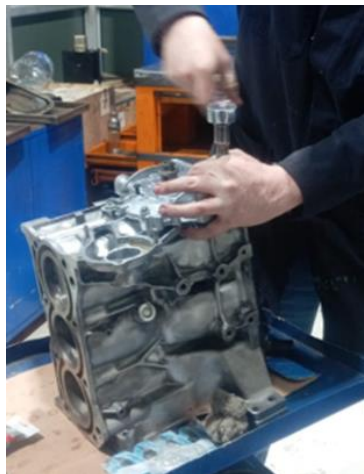
Figura 32 Montaje de la Bomba de Aceite
