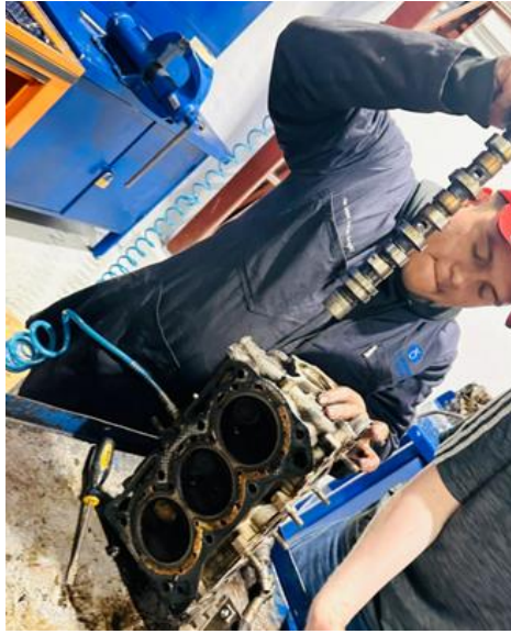
Figura 11 Desmontaje del Árbol de levas
