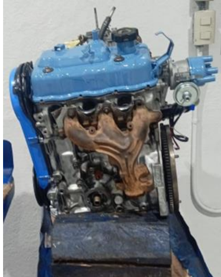
Figura 45 Colocación de la Tapa de Válvulas
