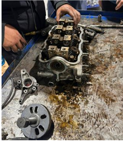
Figura 9 Desarmado de Balancines
