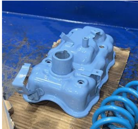
Figura 21 Tapa de Válvulas Restaurada
