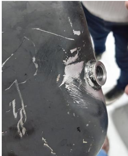
Figura 19 Limpieza y Restauración del Tapón del Cárter
