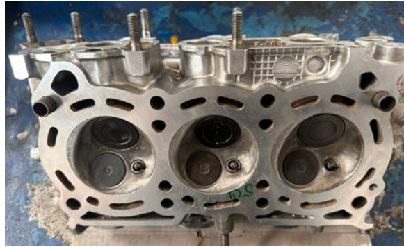
Figura 23 Colocación de Válvulas
