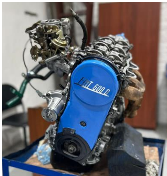
Figura 44 Colocación de Tapa de Distribución
