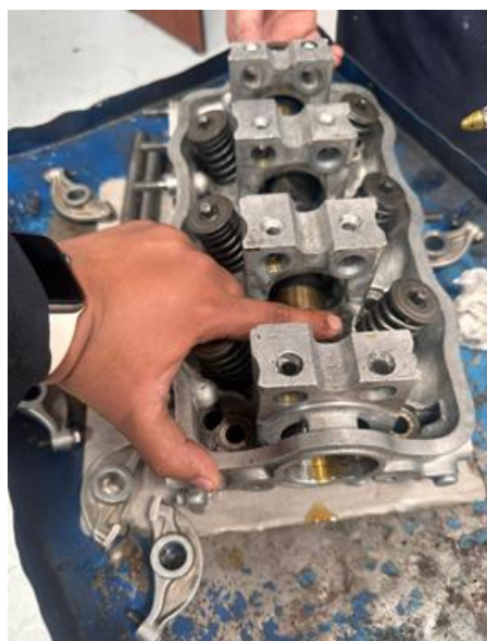
Figura 24 Montaje del Árbol de levas
