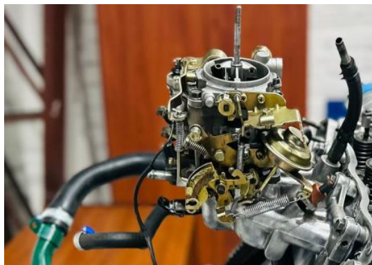
Figura 42 Montaje de Carburador
