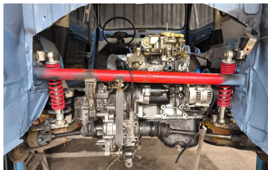
Figura 50 Montaje del Motor en el Vehículo
