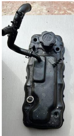
Figura 6 Tapa de Válvulas Desmontada
