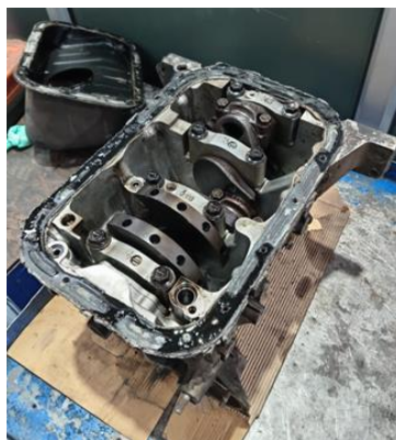
Figura 16 Desmontaje de Bancadas de Cigüeñal
