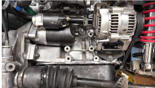
Figura 49 Montaje del Motor de Arranque
