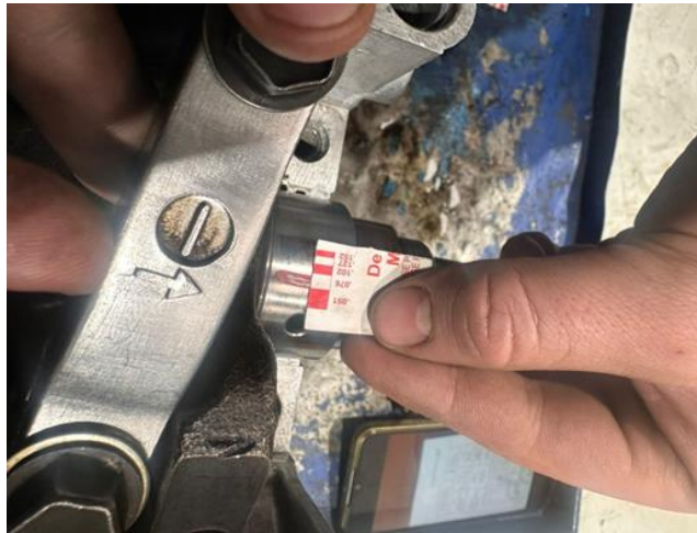
Figura 27 Prueba del Paso de Aceite
