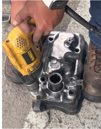
Figura 7 Tapa de Válvulas sin Pintura
