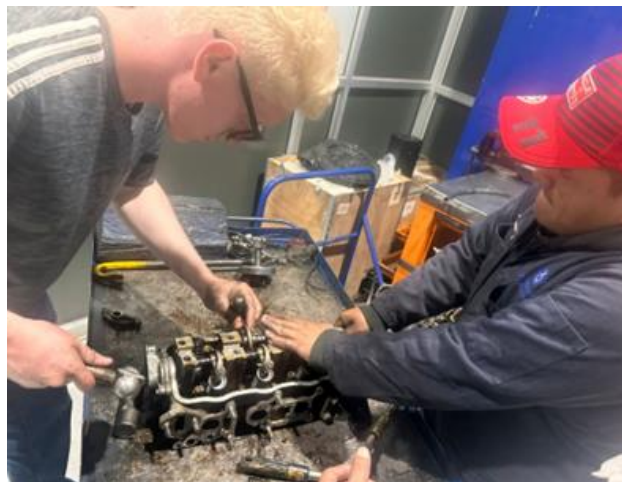
Figura 8 Desarmado de Ejes de Balancines
