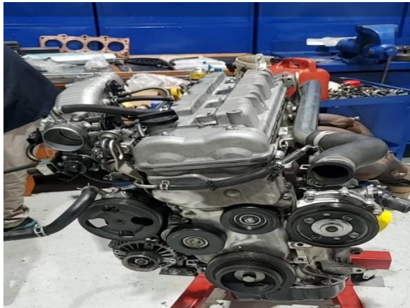
Figura 17: colocación de sistemas auxiliares
