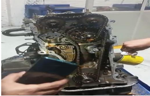
Figura 3: Sistema de distribución
