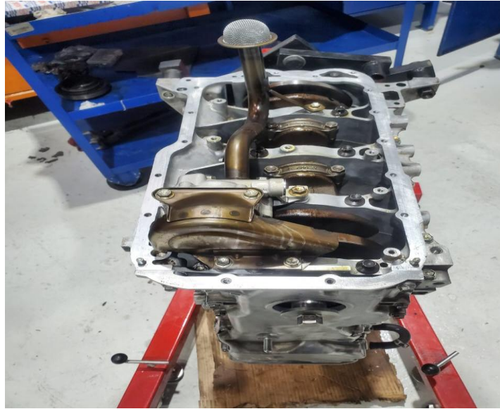
Figura 10: Armado de bomba de aceite
