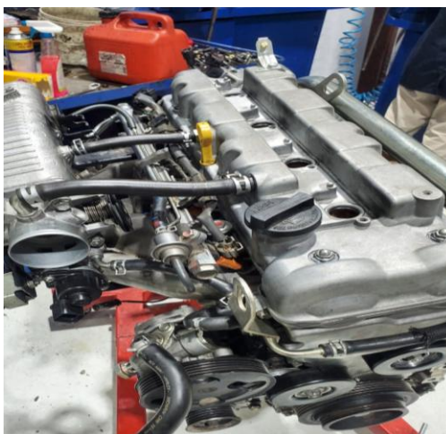
Figura 16: colocación de tapa válvulas y poleas
