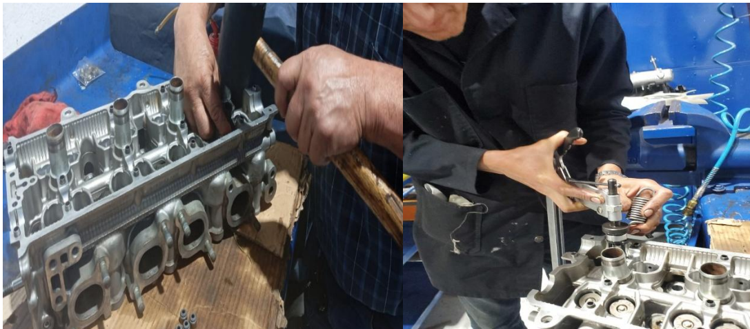
Figura 11: Colocación de sellos de válvulas y muelles
