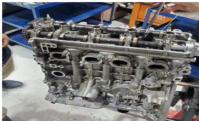
Figura 13: colocacion de los taques y arbol de levas
