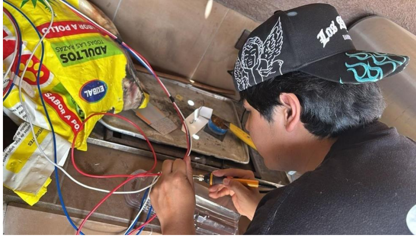
Figura 16: Realizando soldaduras para una mejor unión, arnés nuevo.
