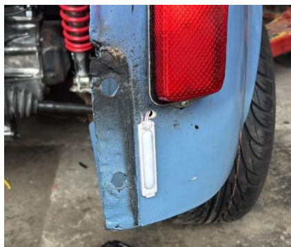
Figura 29: Pastillas LED instaladas para luz de retro.
