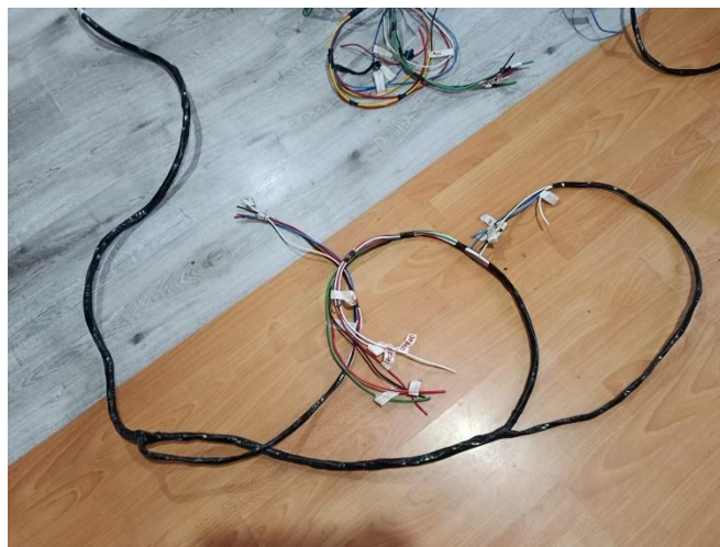
Figura 17: Proceso de ensamble, arnés nuevo.
