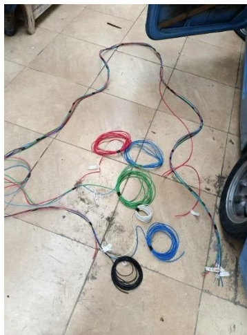
Figura 15: Inicio del ensamble, arnés nuevo.
