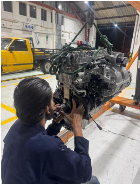
Figura 43 Instalación de retén
