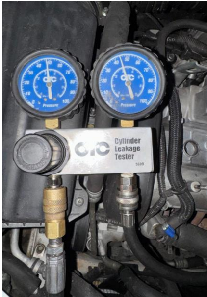
Nota: Verificación de fugas en cilindro 3
