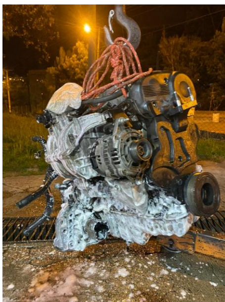
Figura 7 Limpieza de motor
