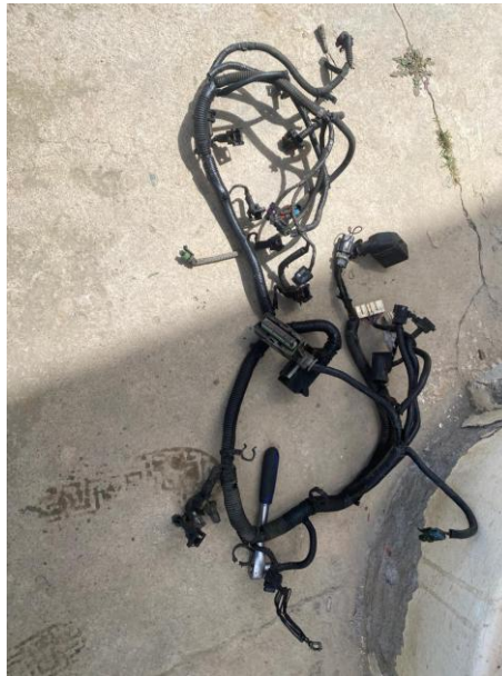
Figura 4 Extracción de arnés
