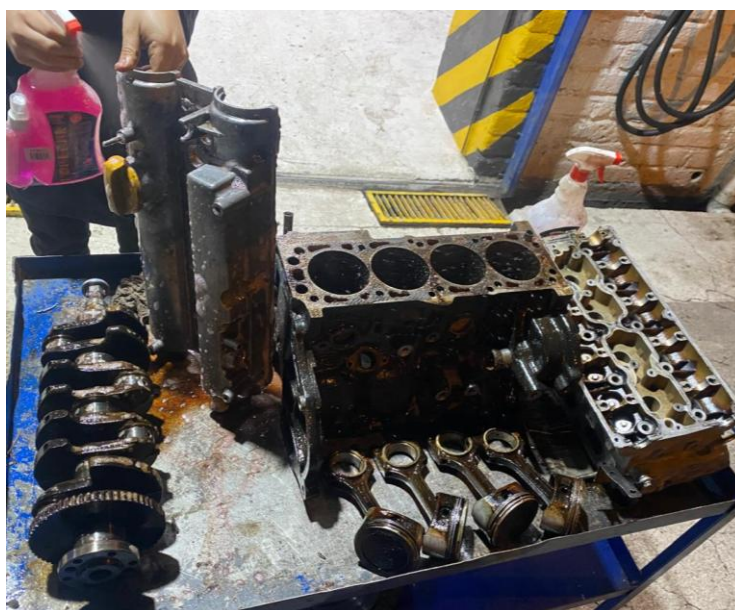
Figura 14 Limpieza componentes internos
