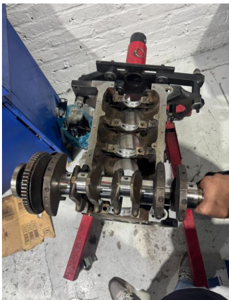
Figura 27 Instalación de cigüeñal
