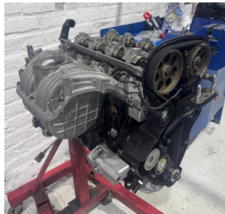
Figura 40 Armado de admisión
