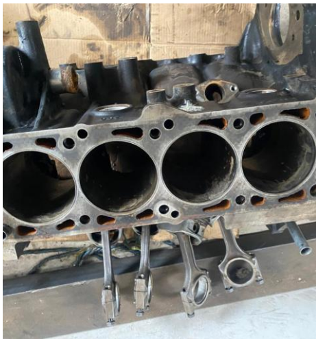
Figura 15 Bloque motor con daños
