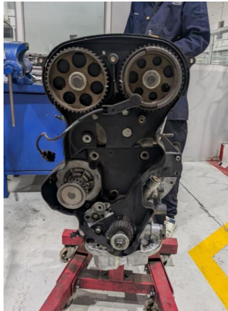
Figura 9 Sistema de distribución
