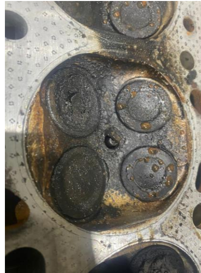
Nota: Estado de válvulas y cámara de combustión
