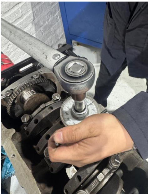
Figura 31 Torque a las bielas
