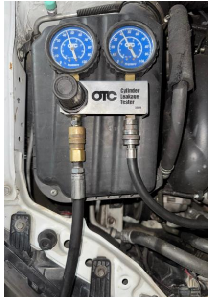
Nota: Verificación de fugas en cilindro 4
