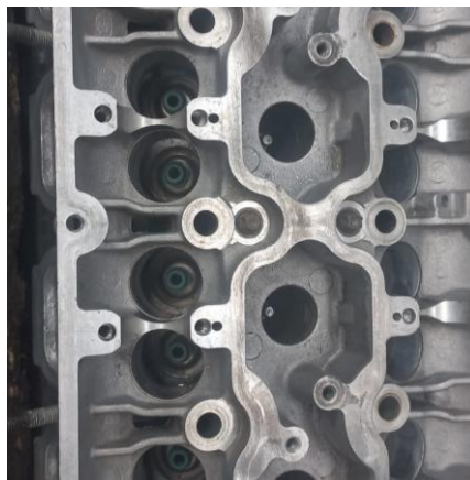
Figura 23 Reemplazo sellos de válvula
