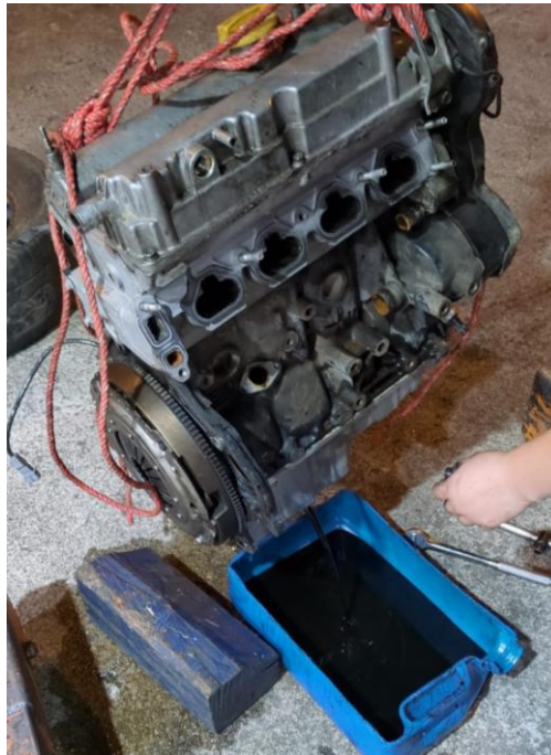
Figura 6 Aceite lubricante extraído
