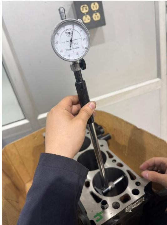
Figura 25 Pruebas con alesómetro
