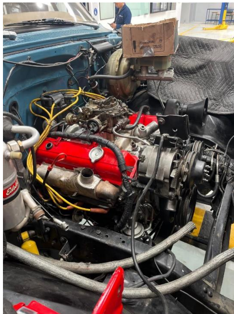
Figura 41. Motor ya instalado las partes para dar el primer encendido
