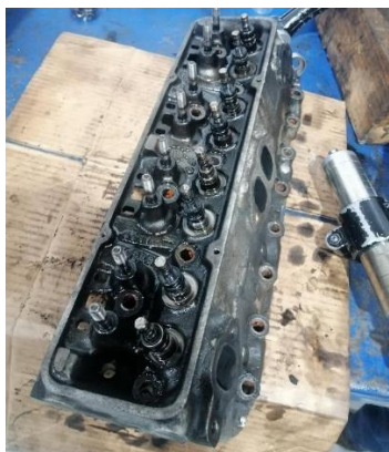
Figura 16. Cabezotes sacados de la parte inferior del bloque motor
