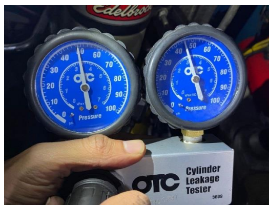
Figura 2. Prueba de fugas con el manómetro para el cilindro 8
