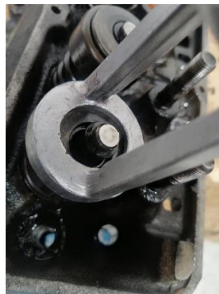
Figura 17. Desarmado de válvulas
