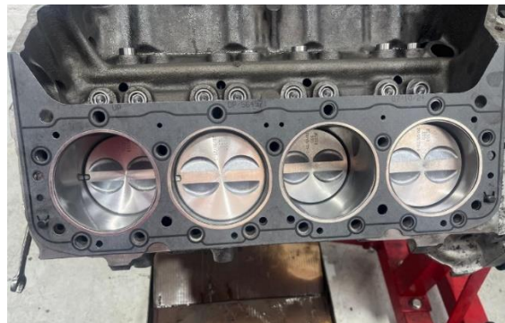
Figura 49. Prueba de empaque del cabezote
