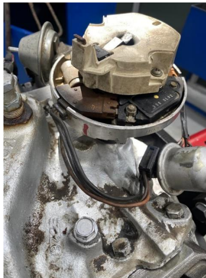
Figura 35. Distribuidor armado correctamente.
