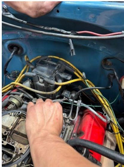
Figura 5. Desconexión de las matrices del distribuidor
