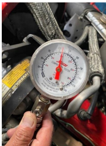
Figura 1. Compresión del cilindro número 1
