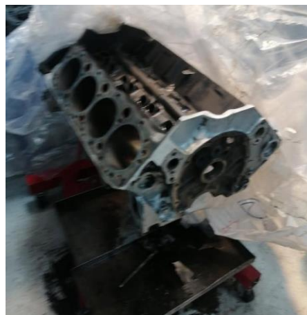
Figura 19. Bloque motor limpio y listo para llevar a la rectificadora
