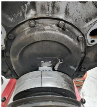
Figura 13. Procediendo al desmontaje de la distribución
