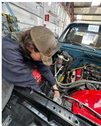
Figura 4. Despiece de todas las mangueras de refrigeración del motor
