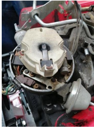
Figura 12. Desmontaje de distribuidor
