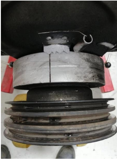
Figura 14. Balanceador armónico procediendo a ser retirado del motor
