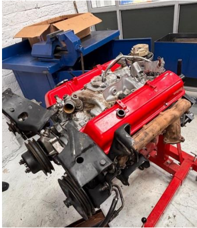
Figura 36. Motor armado para montar en el vehículo.
