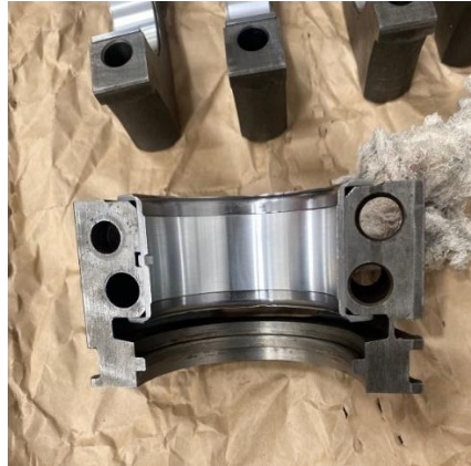
Figura 24. Bancadas de las bielas listas para ser instaladas
