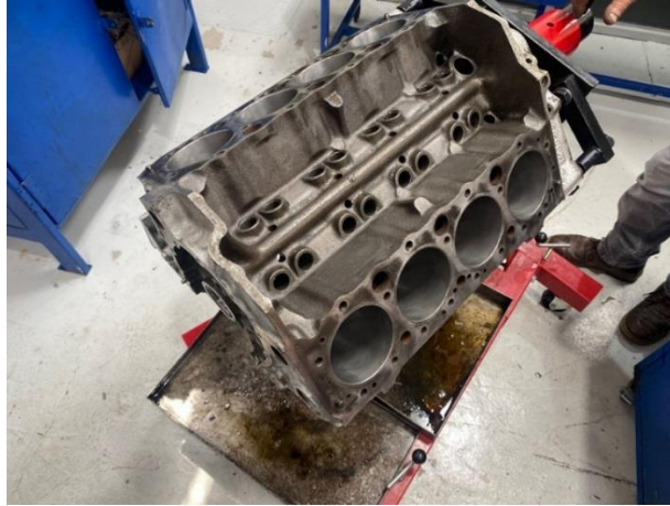
Figura 20. Bloque ya encamisado a estándar y rectificado
