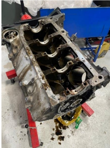
Figura 18. Limpieza de todo el bloque motor
