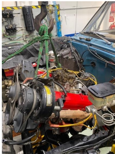
Figura 8. Motor puesto en la aguja para desmontarlo
