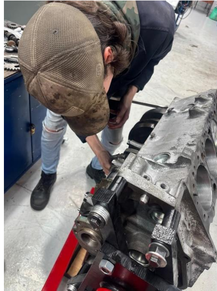
Figura 28. Apriete de las bancadas del cigüeñal.
