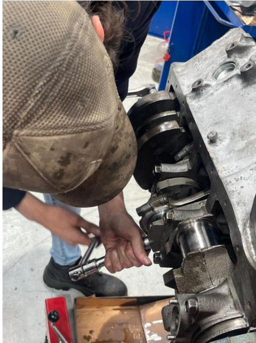
Figura 30. Apriete de las bancadas de la biela.
