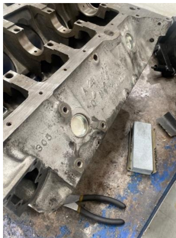
Figura 21. Tapones del bloque motor cambiados
