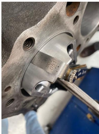
Figura 26. Comprobación de la holgura del cilindro.
