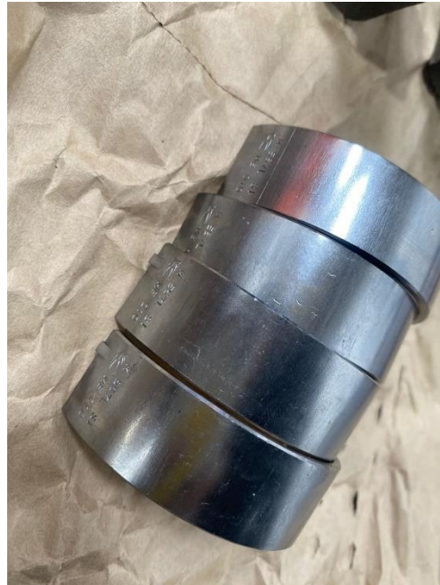
Figura 24. Bancadas de las bielas listas para ser instaladas
