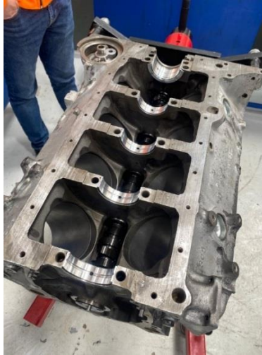
Figura 25. Bancadas instaladas en el bloque motor
