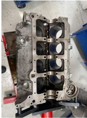
Figura 22. Motor ya lijado y pasado la piedra
