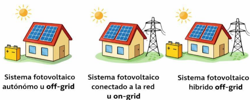
Ilustración 1 Configuraciones de sistemas fotovoltaicos:
