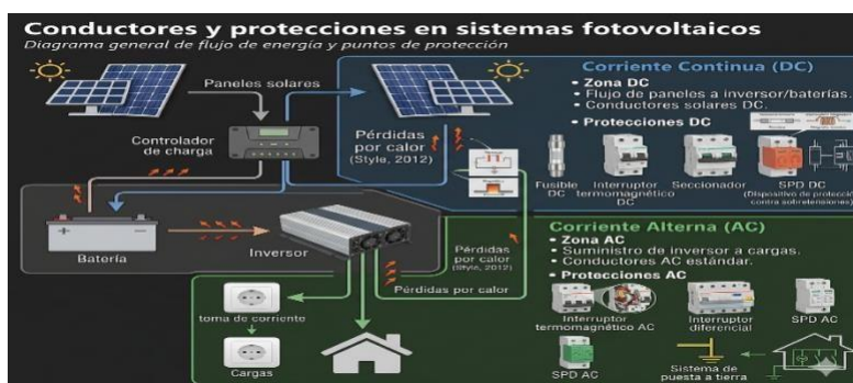
Ilustración 7 Esquema integral de conductores y protecciones
